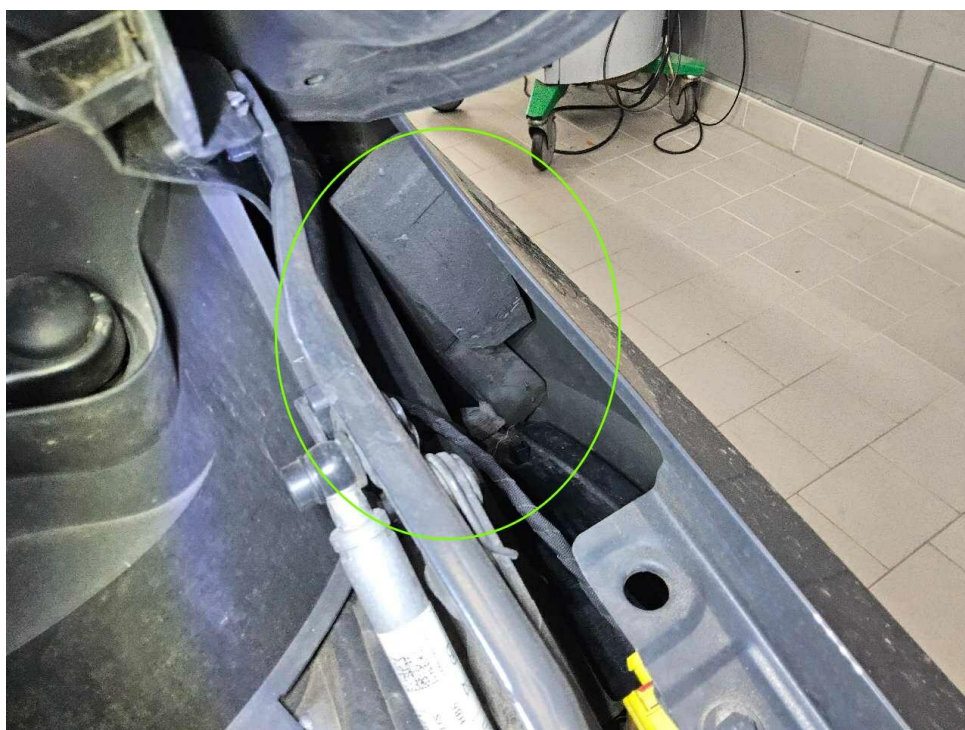
Bild 18 : Motorraum Dämmung Tierverbiss
