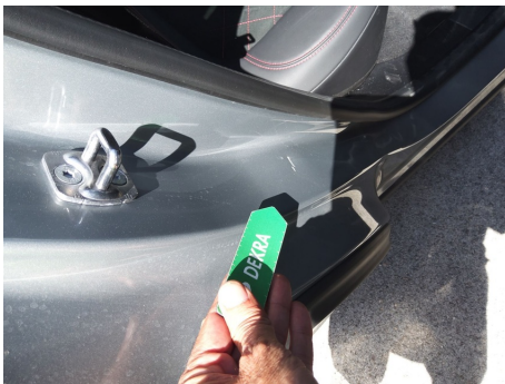
Aleta / Trasero Derecho / Abolladura
