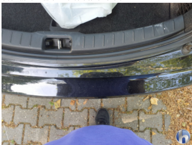
3. Stoßfänger Hinten Oberflächenkratzer - Aufbereiten / Polieren
