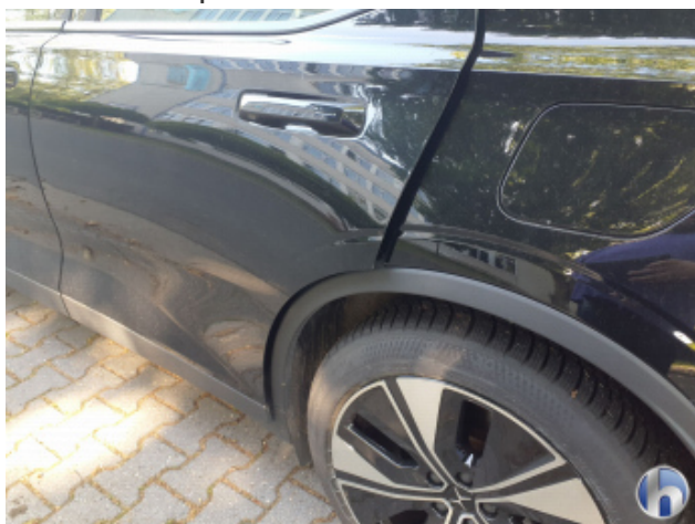
2. Tür Hinten - Links Beschädigt - Instandsetzen und Lackieren
