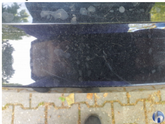
3. Stoßfänger Hinten Oberflächenkratzer - Aufbereiten / Polieren
