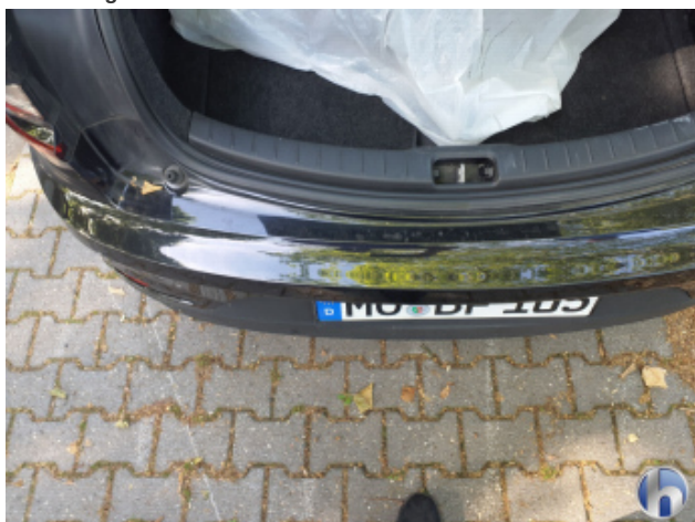
3. Stoßfänger Hinten Oberflächenkratzer - Aufbereiten / Polieren
