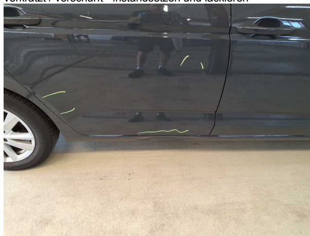
Beschädigung #7: Schweller rechts: Schweller - Delle / Lackschaden - instandsetzen und lackieren
