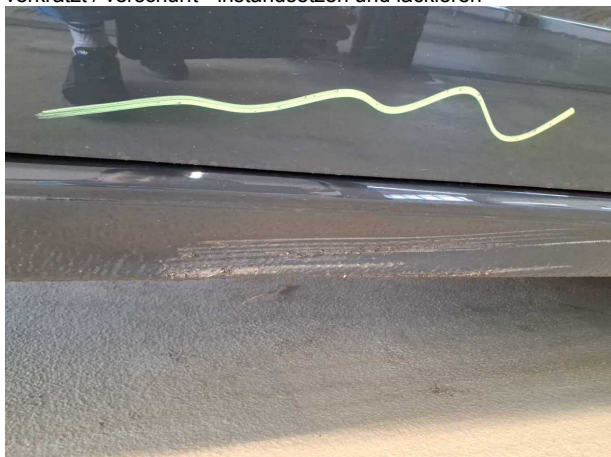
Beschädigung #7: Schweller rechts: Schweller - Delle / Lackschaden - instandsetzen und lackieren
