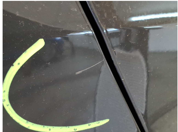
Beschädigung #9: Seitenwand rechts: Seitenwand - Kratzer - instandsetzen und lackieren
