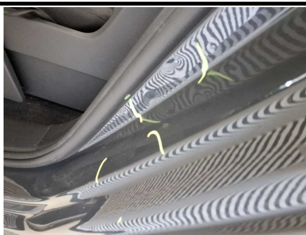
Beschädigung #4: Seitenwand links: Einstieg - Delle / Lackschaden - Smart Repair
