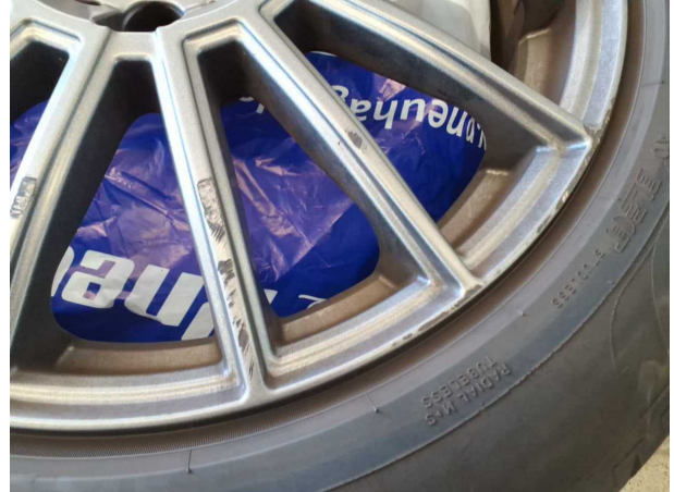
Beschädigung #2: 2.Radsatz: 1 Leichtmetallfelge - verkratzt / verschürft - kein Abzug
