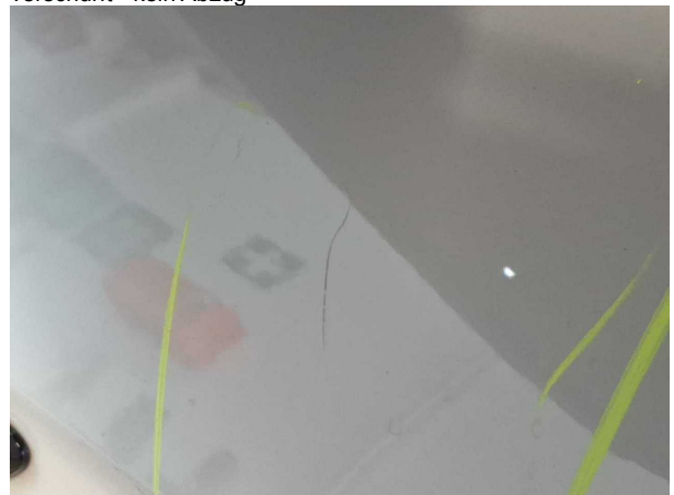
Beschädigung #3: Tür vorn links: Tür - Kratzer - auslegen / polieren
