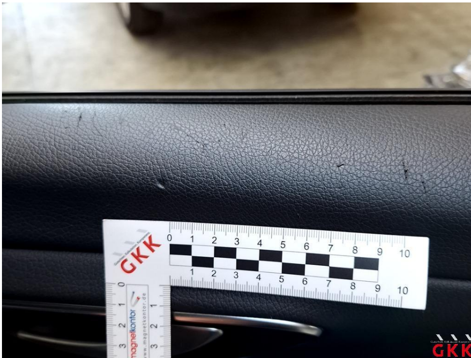
Bild 33 Tür vorne rechts, Innenverkleidung -Standard-, beschädigt, Smartrepair
