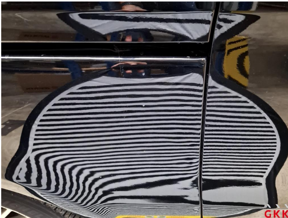
Bild 27 Seitenwand rechts, unterhalb, Reparaturmangel, instand setzen - lackieren
