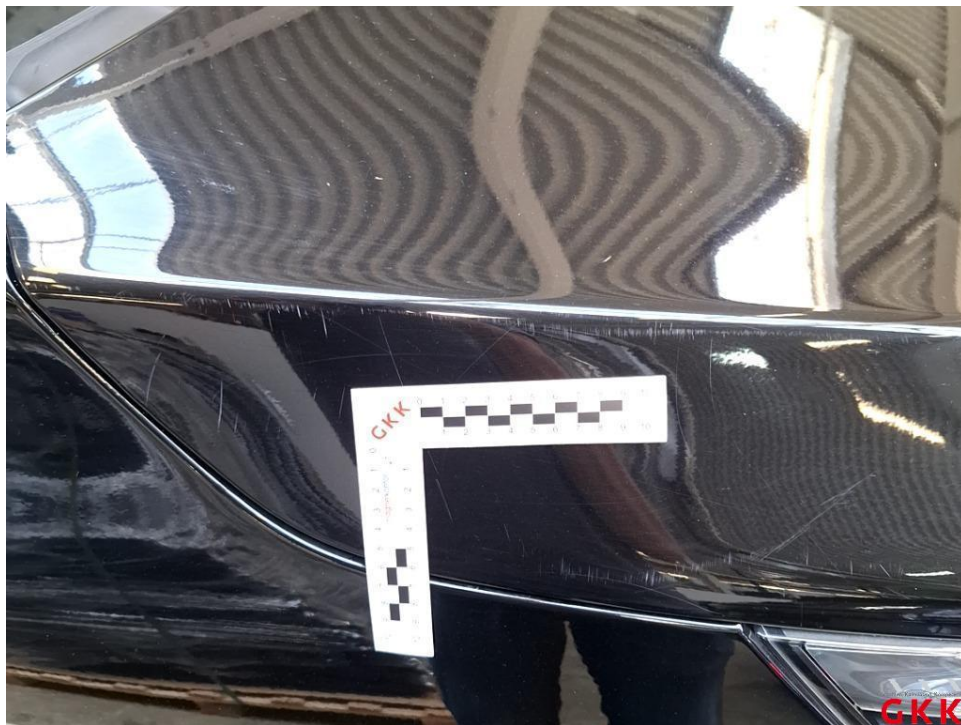
Bild 18 Motorhaube, verkratzt, lackieren
