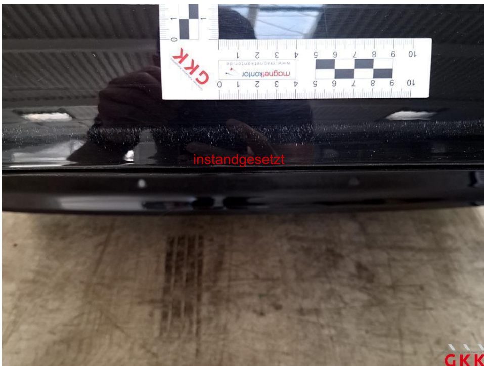
Bild 28 Heckklappe, verkratzt, lackieren
