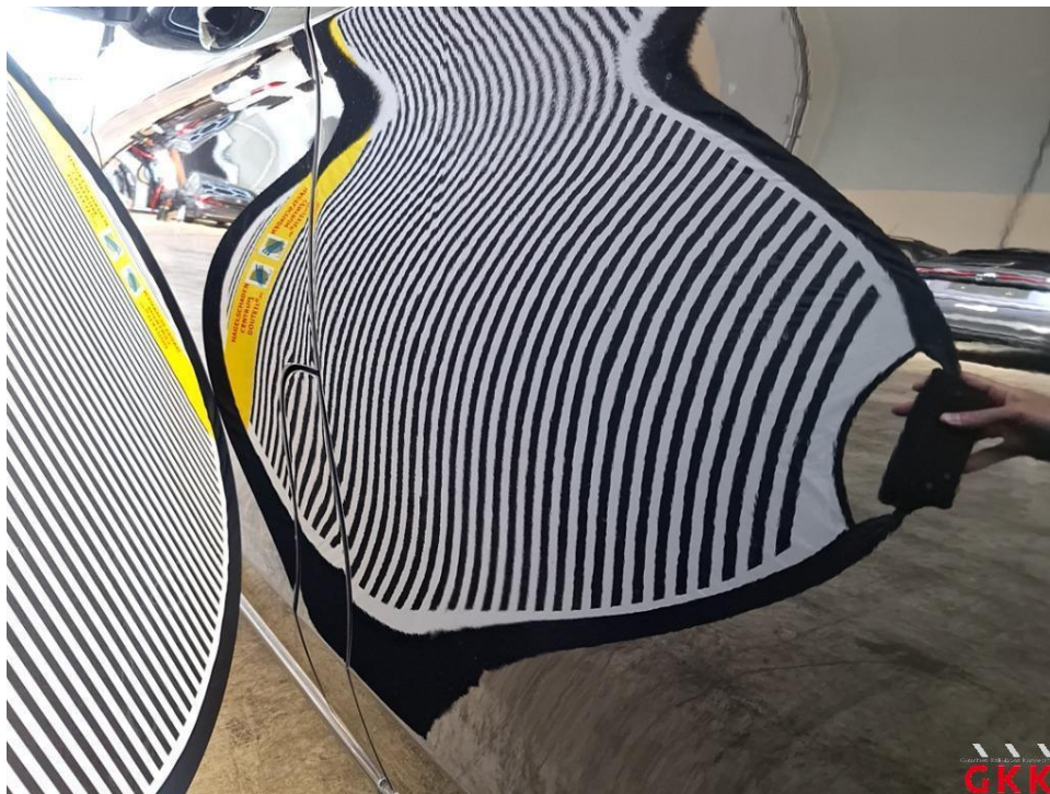
Bild 30 Seitenwand links, Reparaturmangel, instand setzen - lackieren
