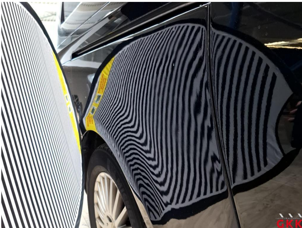
Bild 26 Seitenwand rechts, unterhalb, Reparaturmangel, instand setzen - lackieren
