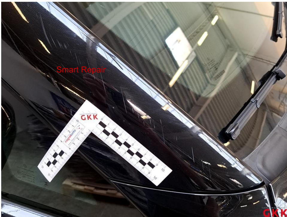
Bild 20 A- Säule rechts, verkratzt, lackieren
