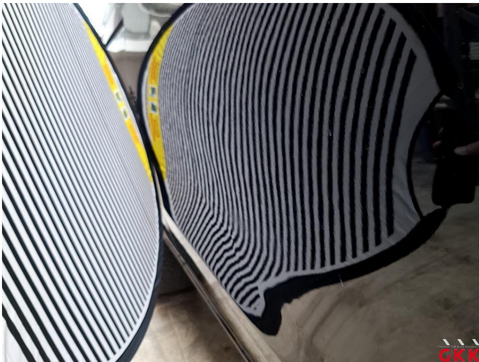
Bild 24 Schiebetür rechts, Reparaturmangel, instand setzen - lackieren
