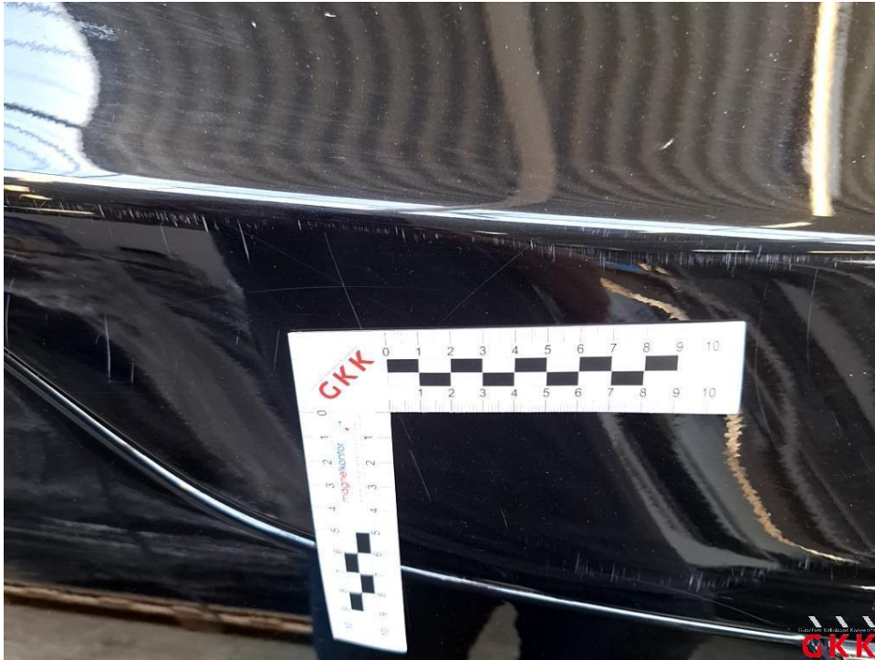
Bild 19 Motorhaube, verkratzt, lackieren
