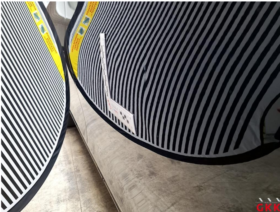
Bild 23 Tür vorne rechts, beschädigt, instand setzen - lackieren
