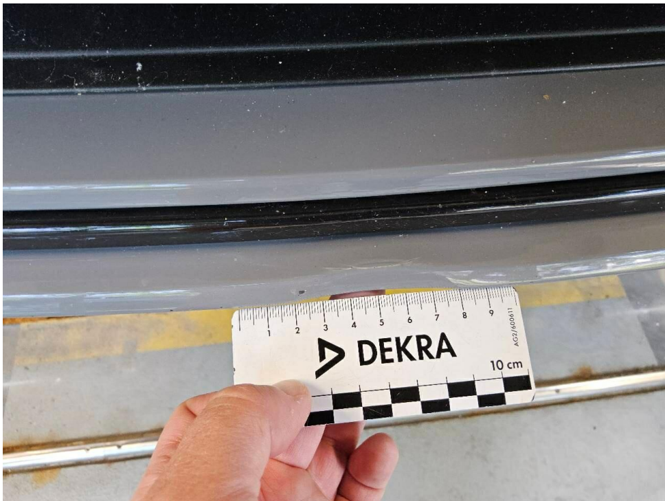
Bild 21 : Stoßfänger und Blende vorne rechts und gebrochen
