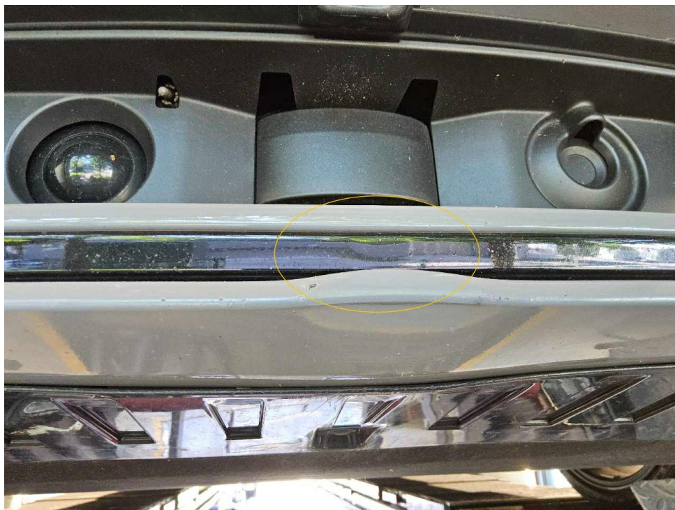
Bild 26 : Stoßfänger und Blende vorne rechts und gebrochen und Lackabplatzer
