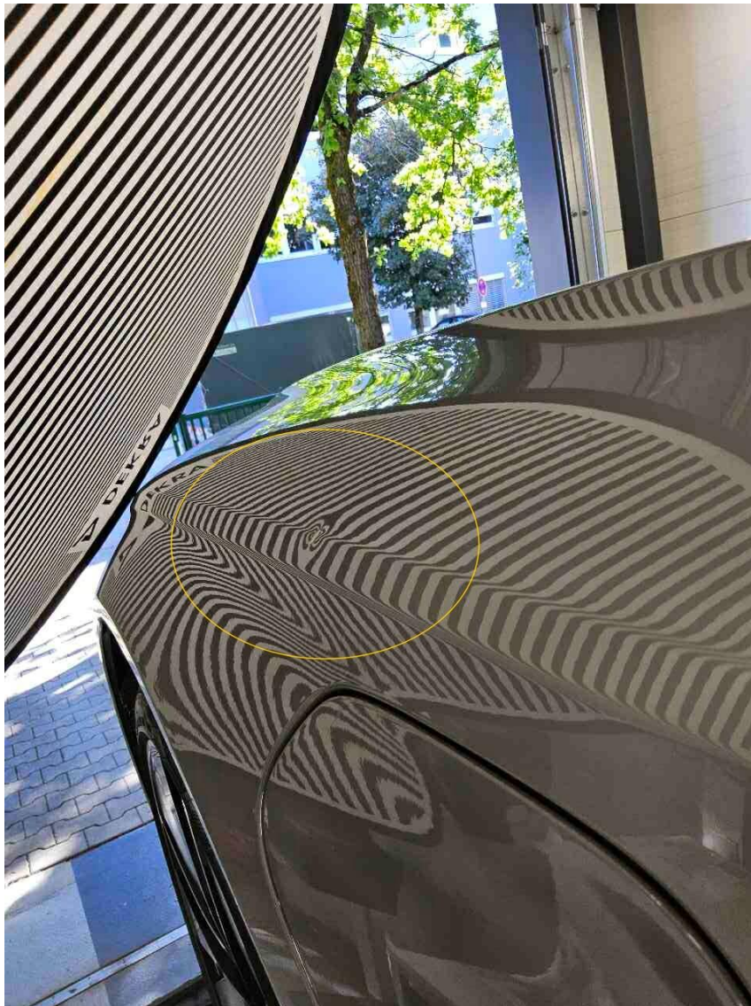
Bild 17 : Kotflügel links zerkratzt und deformiert
