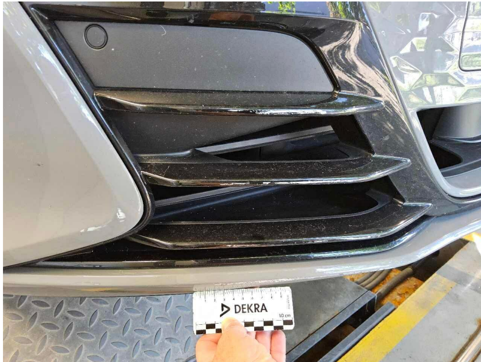
Bild 23 : Stoßfänger und Blende vorne rechts und gebrochen
