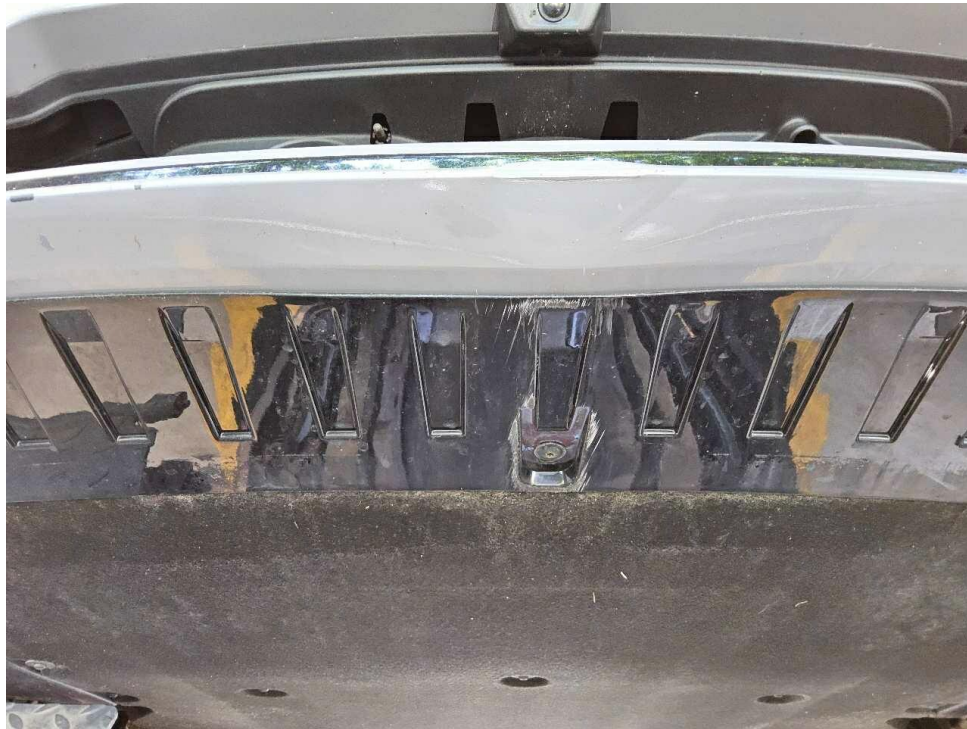
Bild 25 : Stoßfänger und Blende vorne rechts und gebrochen und Lackabplatzer
