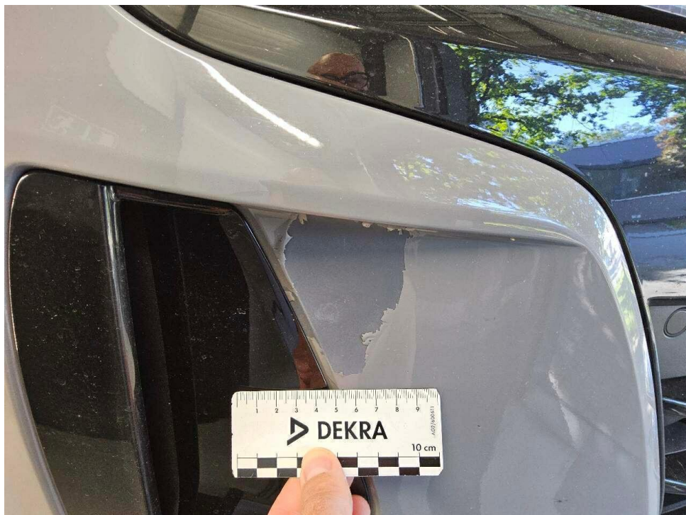
Bild 24 : Stoßfänger und Blende vorne rechts und gebrochen
