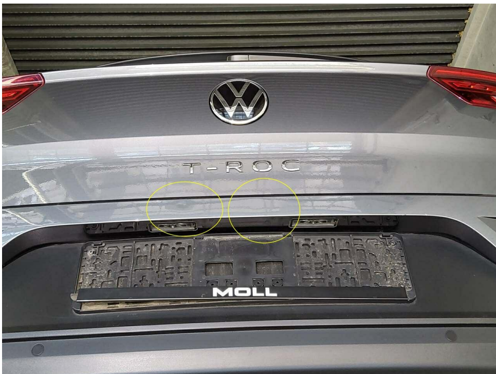
Bild 16 : Stoßfänger hinten Kratzer und eingedellt
