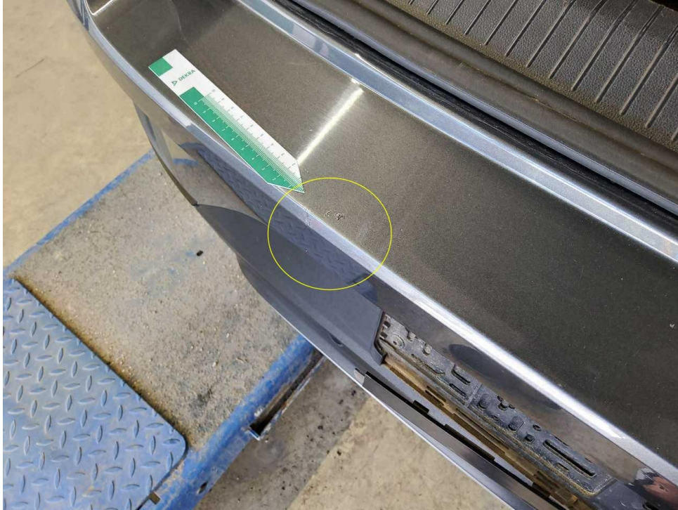
Bild 17 : Stoßfänger hinten Kratzer und eingedellt
