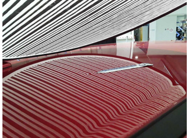
Beschädigung #1: Fahrzeugdach: Dach - Delle(n) - sanft instandsetzen
