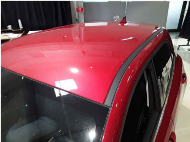
Beschädigung #1: Fahrzeugdach: Dach - Delle(n) - sanft instandsetzen
