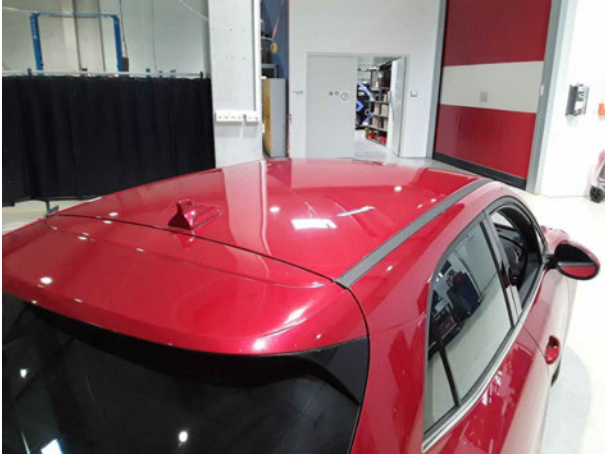
Beschädigung #1: Fahrzeugdach: Dach - Delle(n) - sanft instandsetzen
