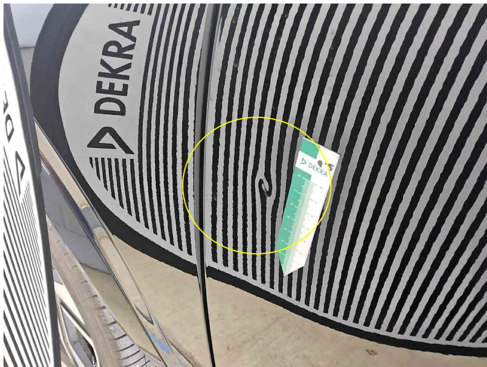
Bild 21 : Tür vorne links, eingedellt, drücken
