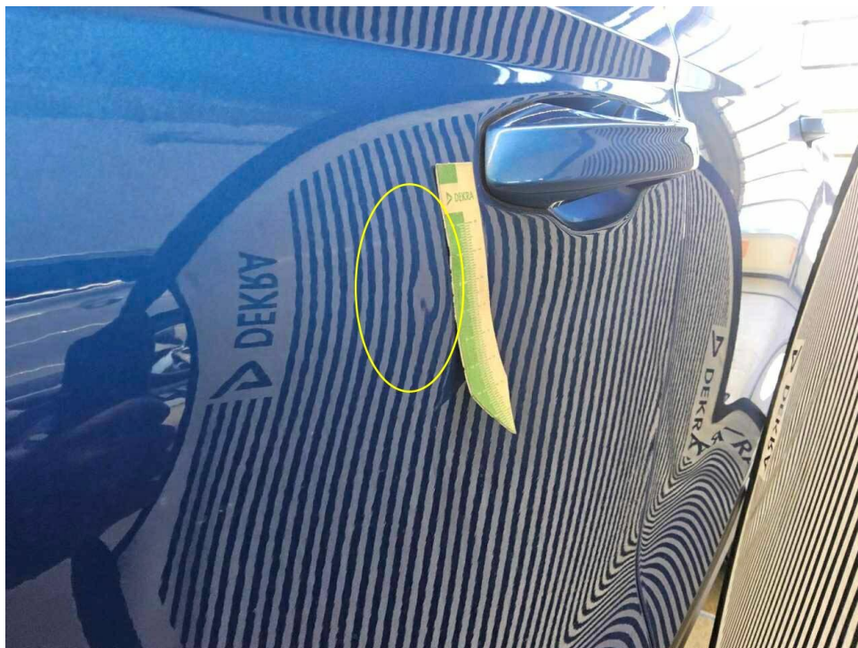
Bild 19 : Tür vorne links, eingedellt, drücken
