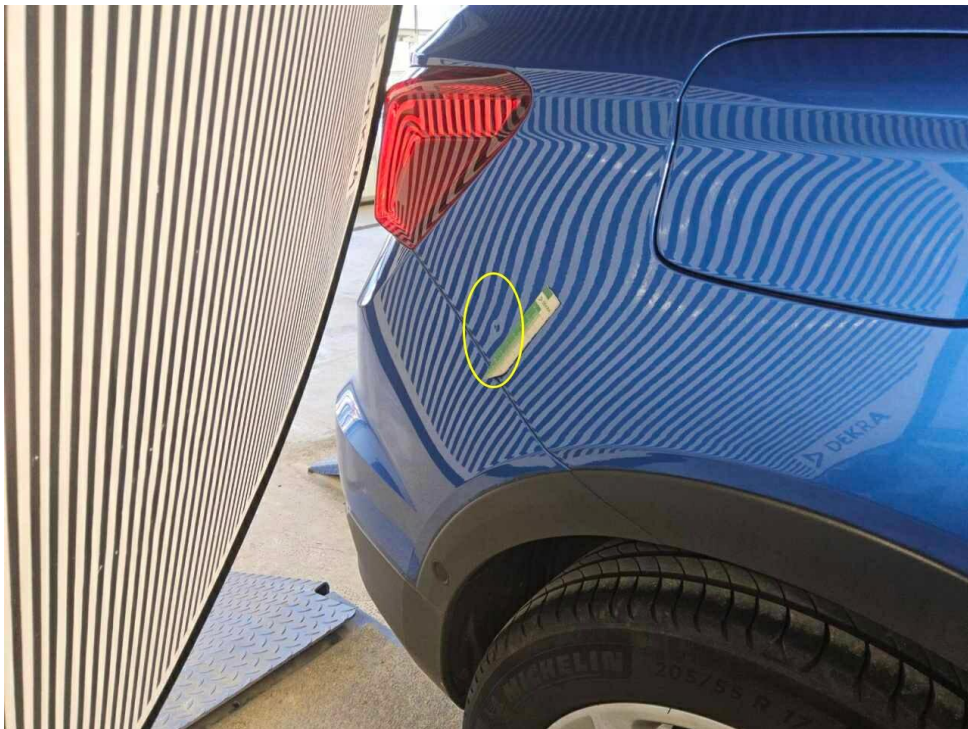
Bild 16 : Seitenteil hinten rechts, eingedellt, drücken
