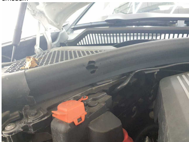
Beschädigung #4: Motor: Motorabdeckung (Dichtung) - beschädigt - erneuern
