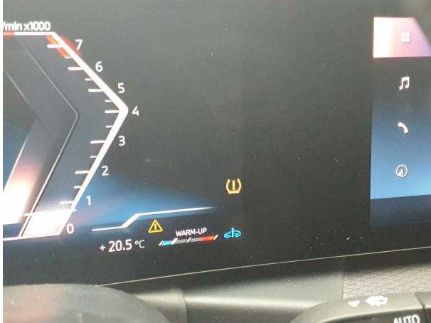
Beschädigung #1: Rad/Reifen: Drucksensor - leuchtet
