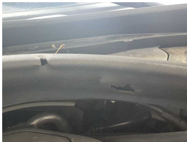
Beschädigung #4: Motor: Motorabdeckung (Dichtung) - beschädigt - erneuern
