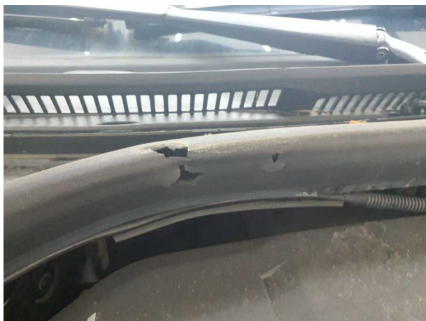
Beschädigung #4: Motor: Motorabdeckung (Dichtung) - beschädigt - erneuern
