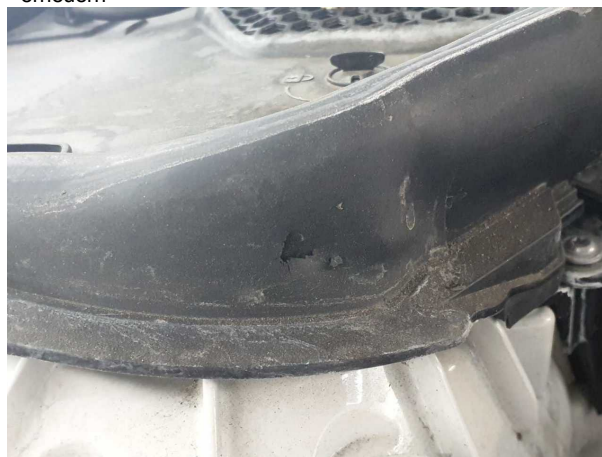
Beschädigung #4: Motor: Motorabdeckung (Dichtung) - beschädigt - erneuern
