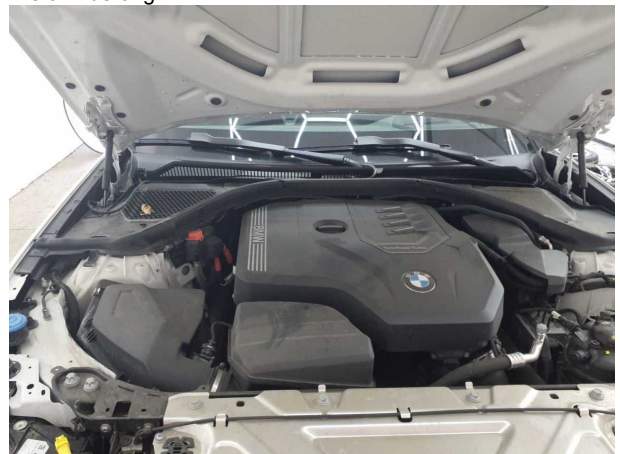
Beschädigung #4: Motor: Motorabdeckung (Dichtung) - beschädigt - erneuern
