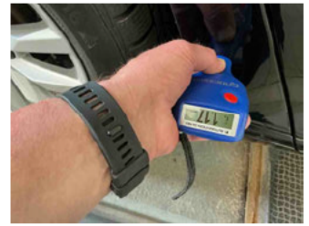
Lackstärke Seitenwand hinten rechts
