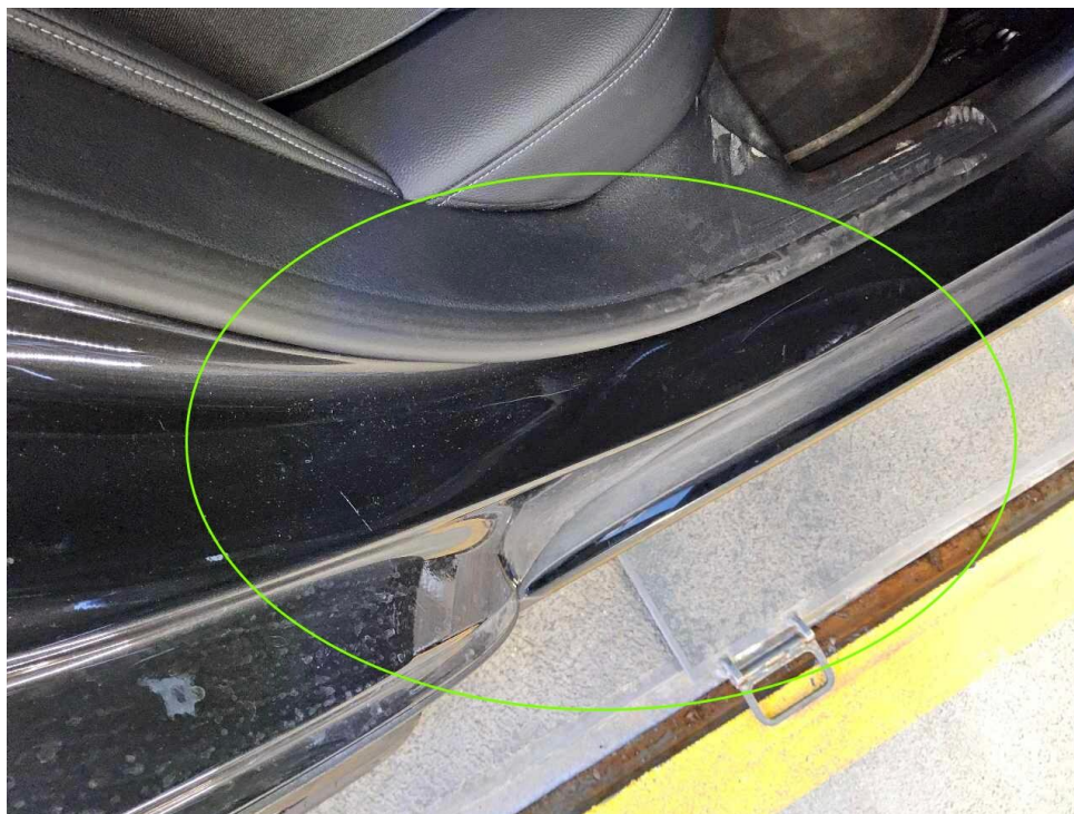
Bild 14 : Einstieg hinten rechts, verkratzt
