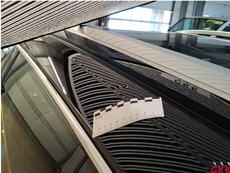
Bild 21 Dach, Holm links, beschädigt, instand setzen - lackieren
