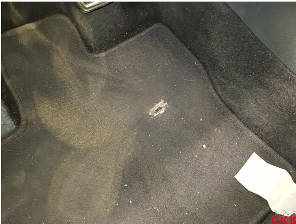
Bild 20 Fußmatte(n), vorne links, beschädigt, ersetzen
