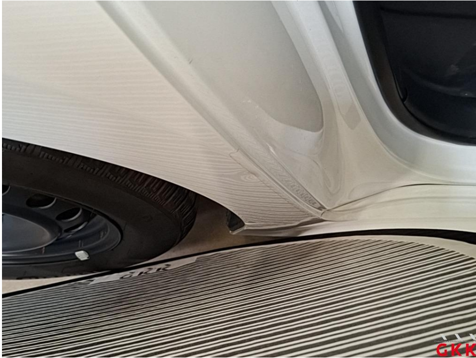
Bild 35 Seitenwand rechts, beschädigt, instand setzen - lackieren
