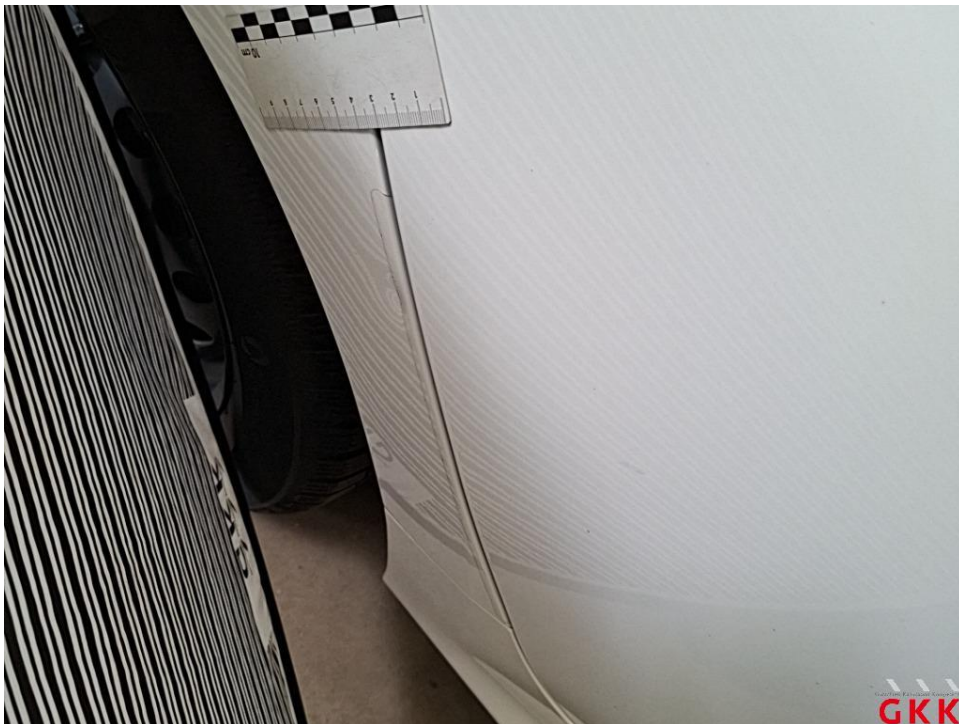
Bild 34 Seitenwand rechts, beschädigt, instand setzen - lackieren
