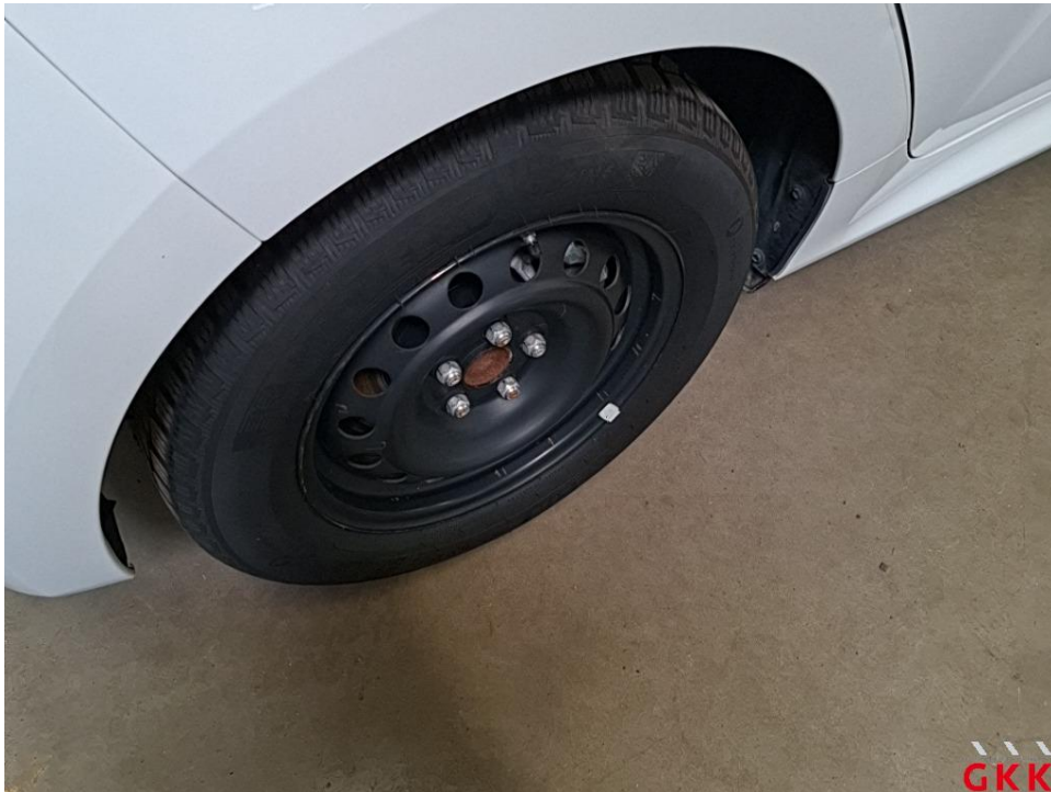
Bild 21 Radkappe(n), hinten rechts, fehlt, ersetzen
