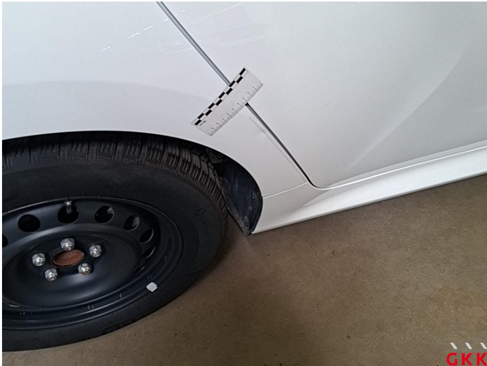
Bild 33 Seitenwand rechts, beschädigt, instand setzen - lackieren
