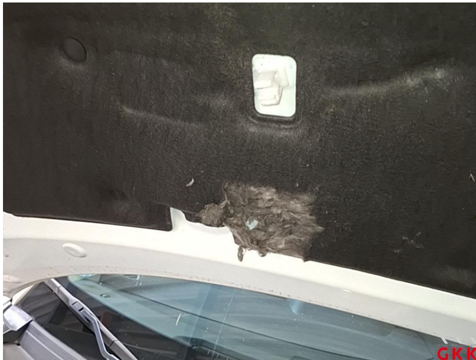
Bild 18 Motorhaube, Dämmmatte, beschädigt, ersetzen
