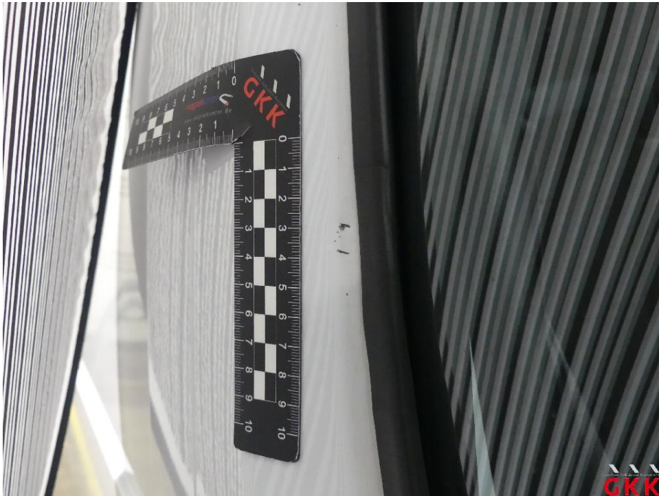
Bild 19 Tür vorne rechts, beschädigt, instand setzen - lackieren
