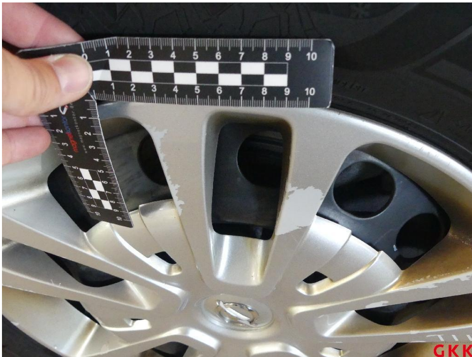
Bild 28 Radkappe(n), hinten links, beschädigt, ersetzen
