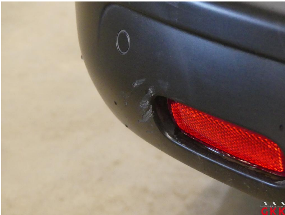
Bild 26 Stoßfänger hinten, Verkleidung -unlackiert-, verkratzt, ersetzen
