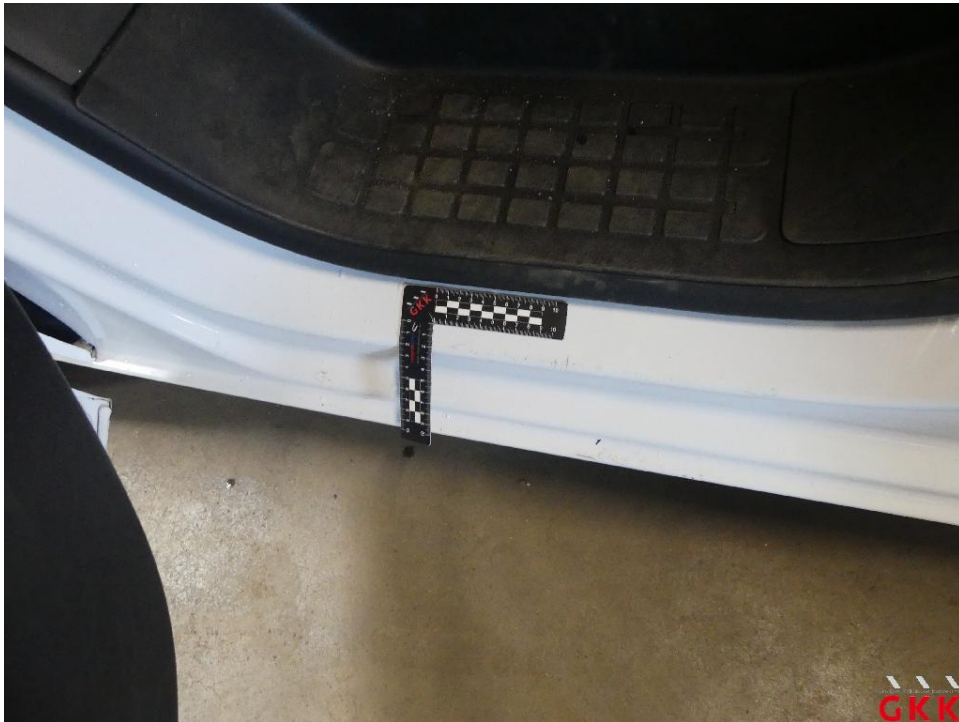
Bild 29 Tür vorne links, Einstieg, verkratzt, Smartrepair
