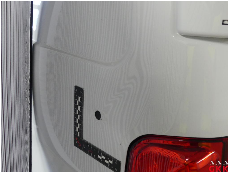
Bild 23 Hecktür rechts, beschädigt, ersetzen
