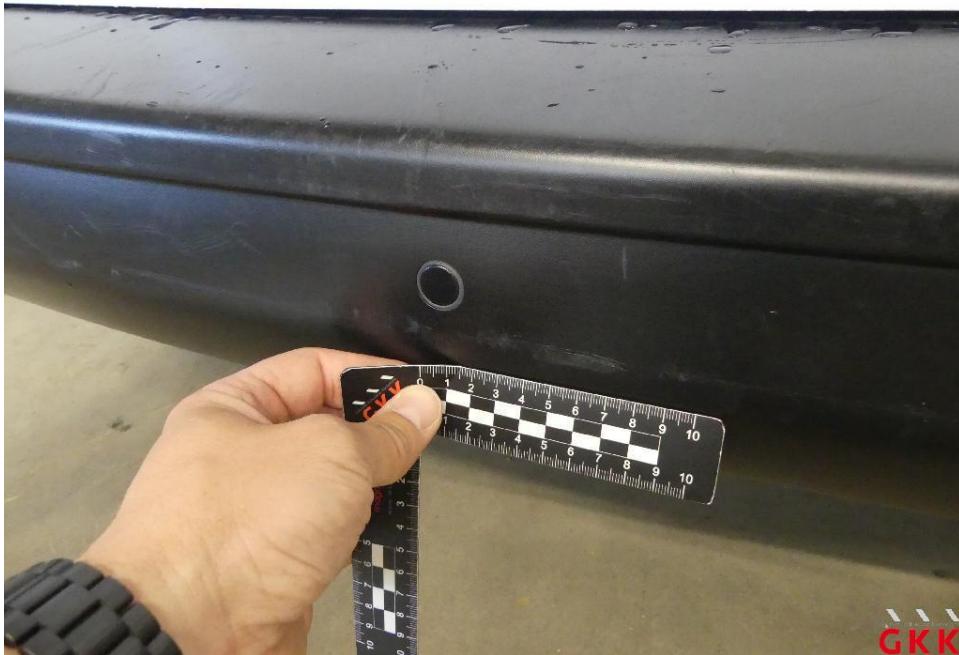
Bild 25 Stoßfänger hinten, Verkleidung -unlackiert-, verkratzt, ersetzen
