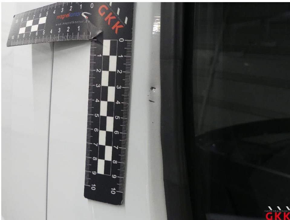
Bild 18 Tür vorne rechts, beschädigt, instand setzen - lackieren
