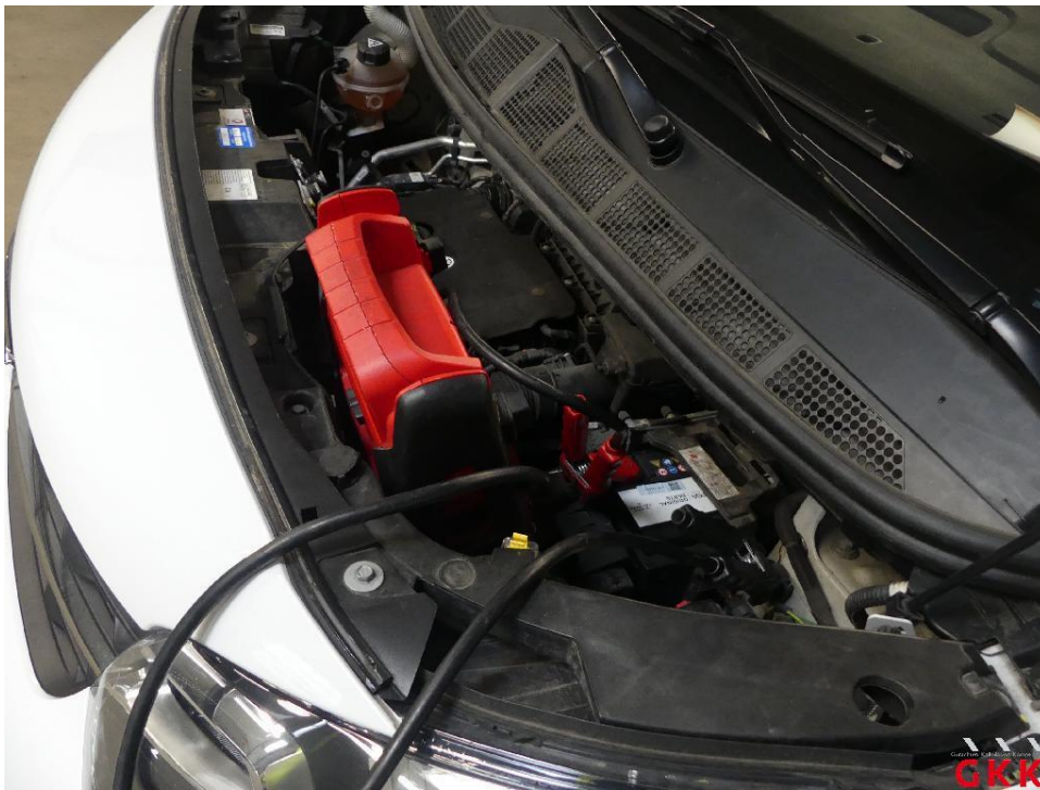
Bild 16 Fahrzeug, Batterie, entladen, prüfen
