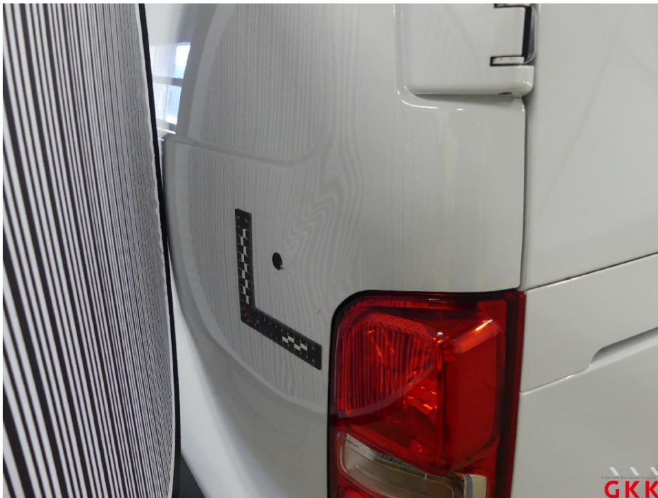
Bild 22 Hecktür rechts, beschädigt, ersetzen
