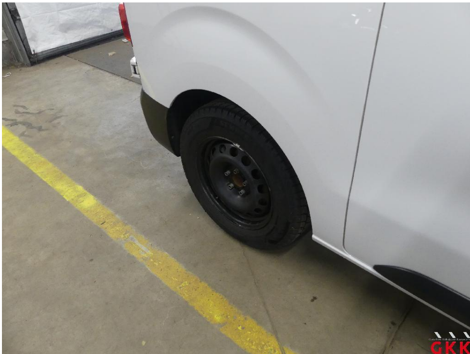
Bild 20 Radkappe(n), hinten rechts, fehlt, ersetzen
