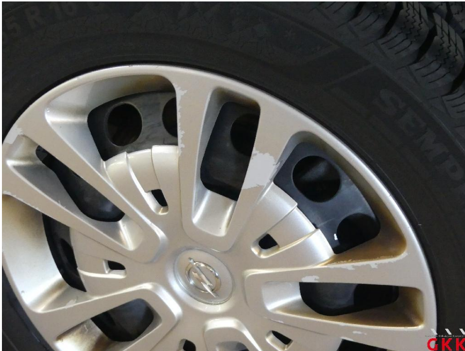
Bild 27 Radkappe(n), hinten links, beschädigt, ersetzen
