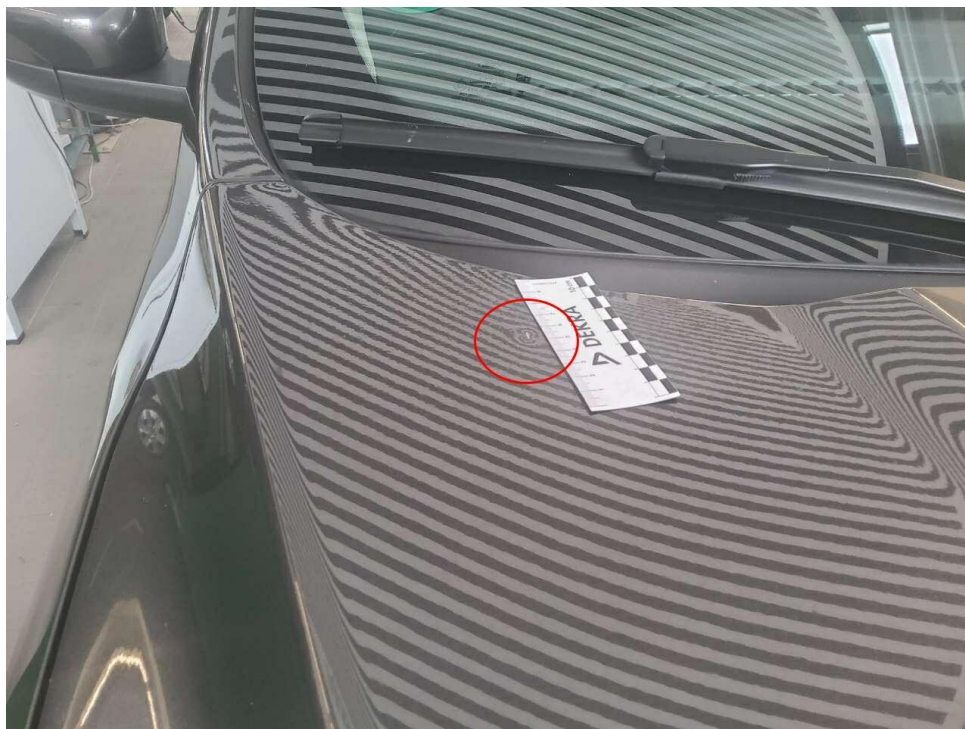
Bild 15 : Motorhaube, eingedellt, instandsetzen und lackieren mit Lackaufbau
