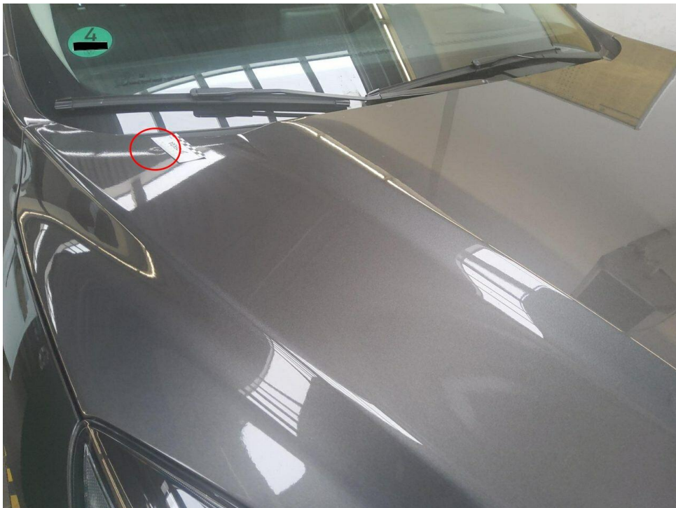
Bild 14 : Motorhaube, eingedellt, instandsetzen und lackieren mit Lackaufbau
