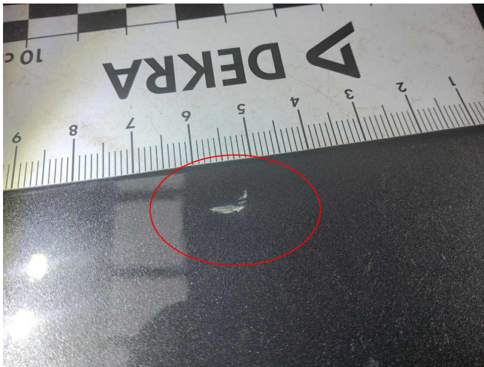
Bild 16 : Motorhaube, eingedellt, instandsetzen und lackieren mit Lackaufbau
