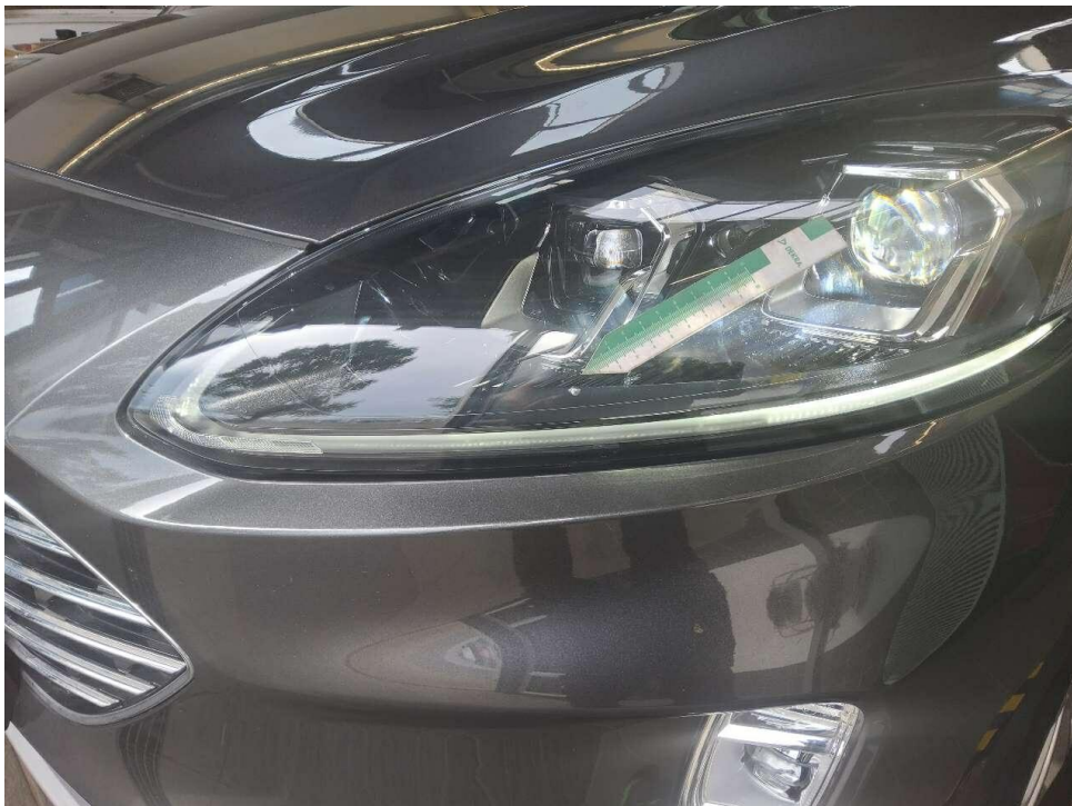
Bild 20 : Scheinwerfer vorn links Steinschlag - ohne Beeinflussung der Betriebs- / Verkehrssicherheit
