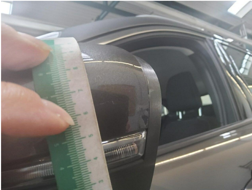
Bild 21 : Außenspiegel links Lackierung, verschrammt, Gebrauchsspur
