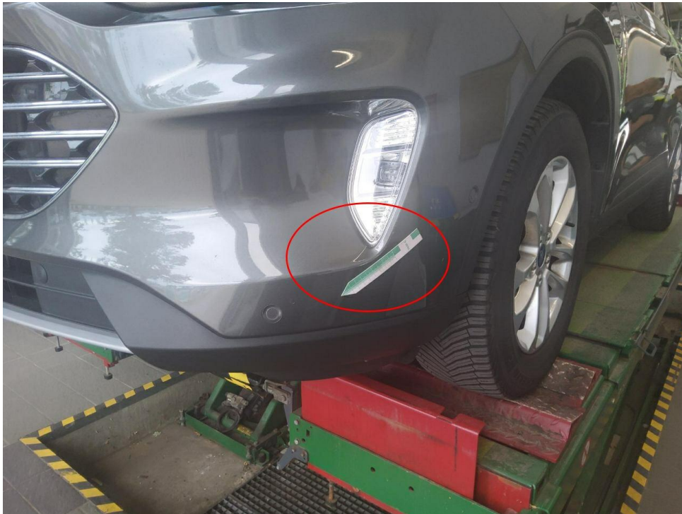
Bild 17 : Stoßfänger vorne Lackierung, zerkratzt, smart repair
