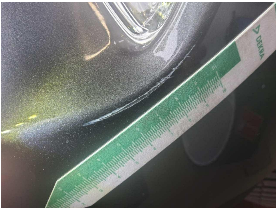
Bild 18 : Stoßfänger vorne Lackierung, zerkratzt, smart repair
