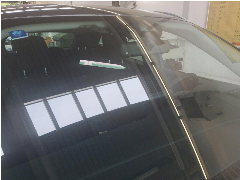
Bild 24 : Frontscheibe, Steinschlag, Gebrauchsspur
