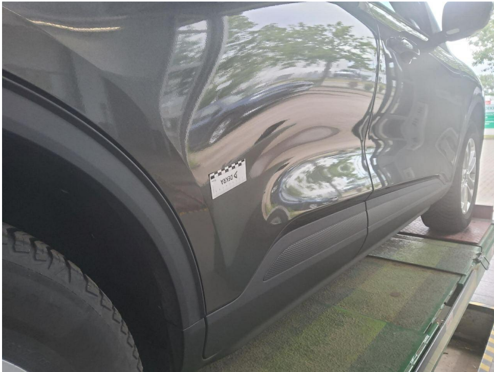
Bild 23 : Tür hinten rechts Lackierung, verschrammt, polieren
