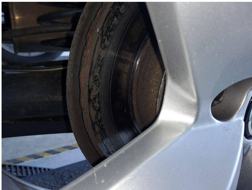
Bild 28 : Bremsscheiben hinten schlechtes Tragbild und korrodiert
