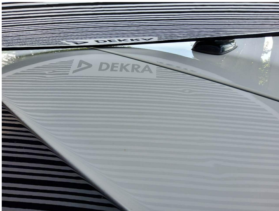
Bild 19 : Dach und Heckklappe mehrfach eingedellt
