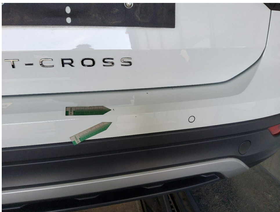
Bild 14 : Stoßfänger hinten verschrammt
