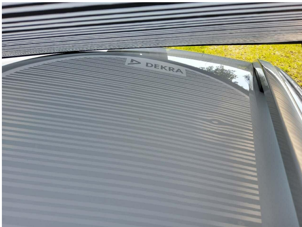
Bild 20 : Dach und Heckklappe mehrfach eingedellt
