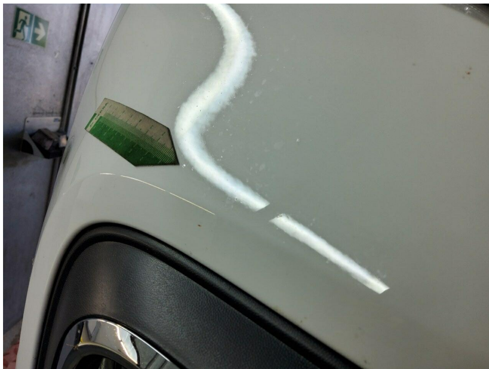
Bild 34 : Stoßfänger vorn Steinschläge
