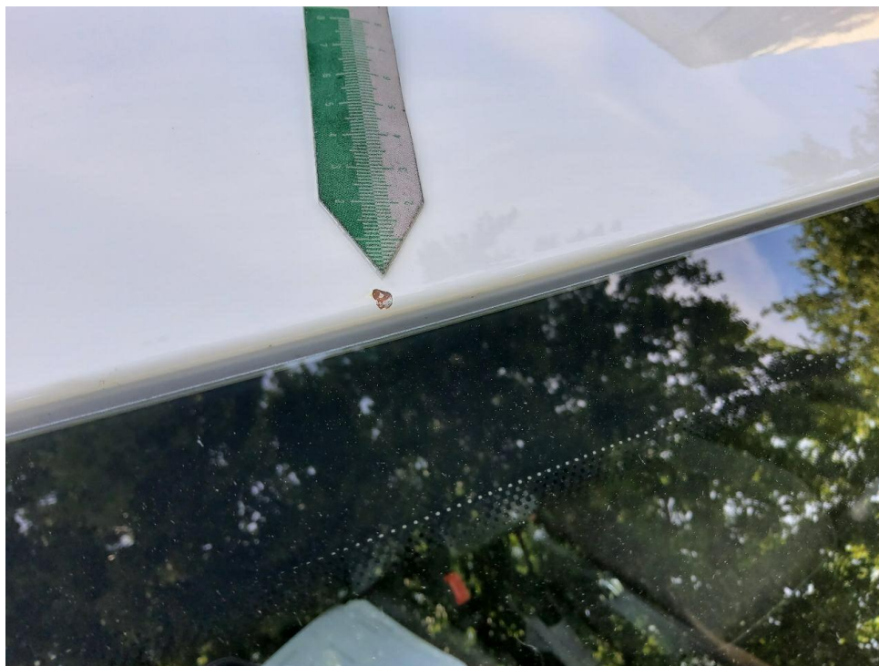
Bild 16 : Dach Steinschlag mit Korrosionsbildung und verschrammt
