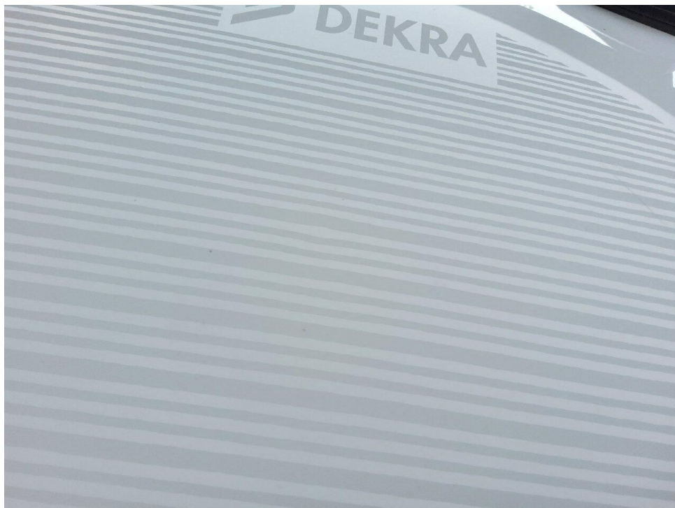
Bild 24 : Dach und Heckklappe mehrfach eingedellt
