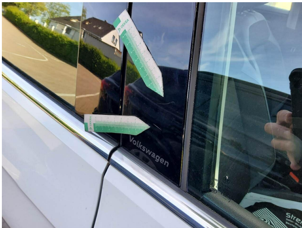
Bild 27 : Türblende vorn rechts verschrammt
