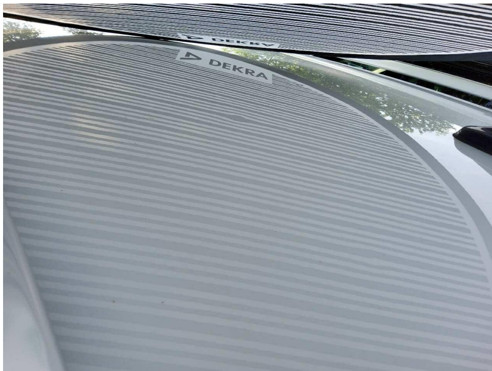
Bild 23 : Dach und Heckklappe mehrfach eingedellt
