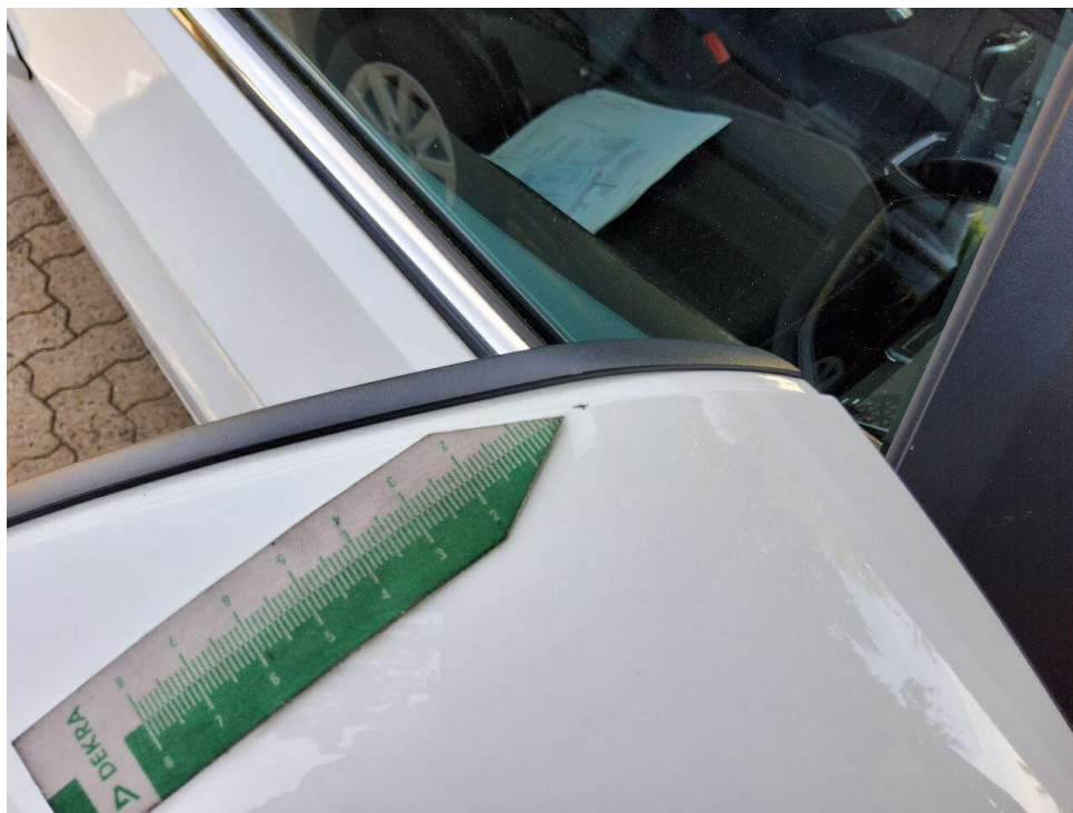
Bild 18 : Spiegel rechts verschrammt
