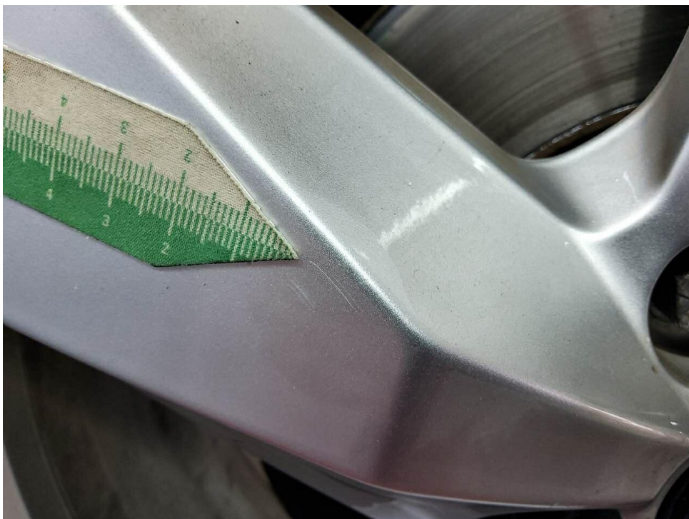
Bild 30 : Alufelge vorn rechts verschrammt
