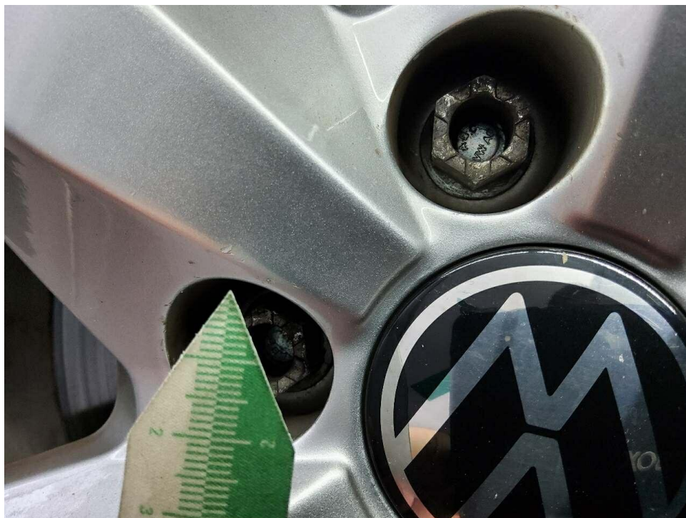
Bild 31 : Alufelge vorn rechts verschrammt
