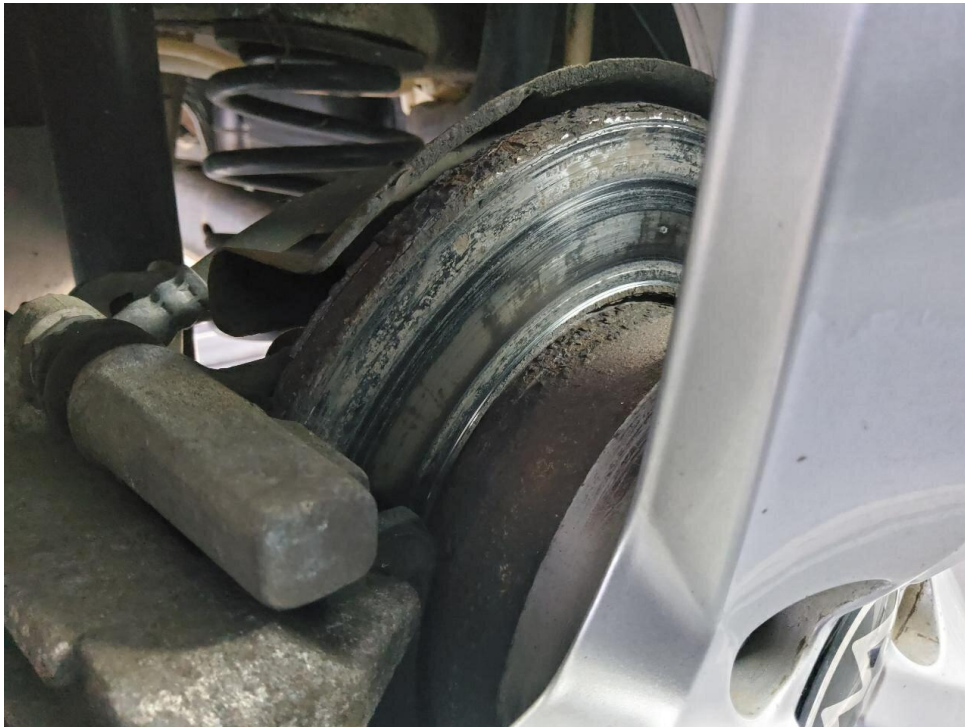
Bild 29 : Bremsscheiben hinten schlechtes Tragbild und korrodiert
