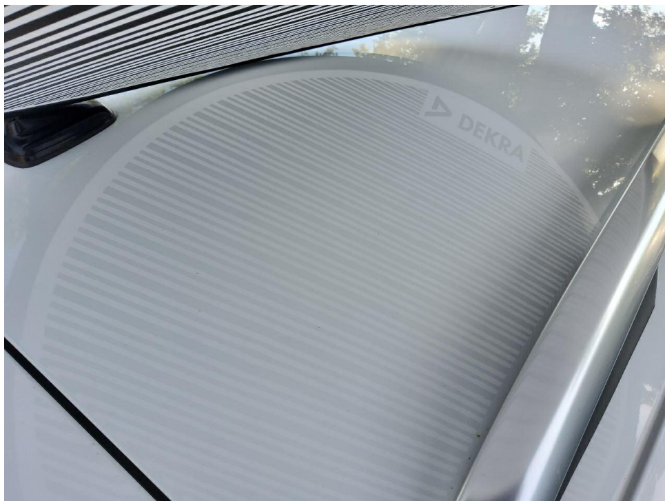
Bild 22 : Dach und Heckklappe mehrfach eingedellt
