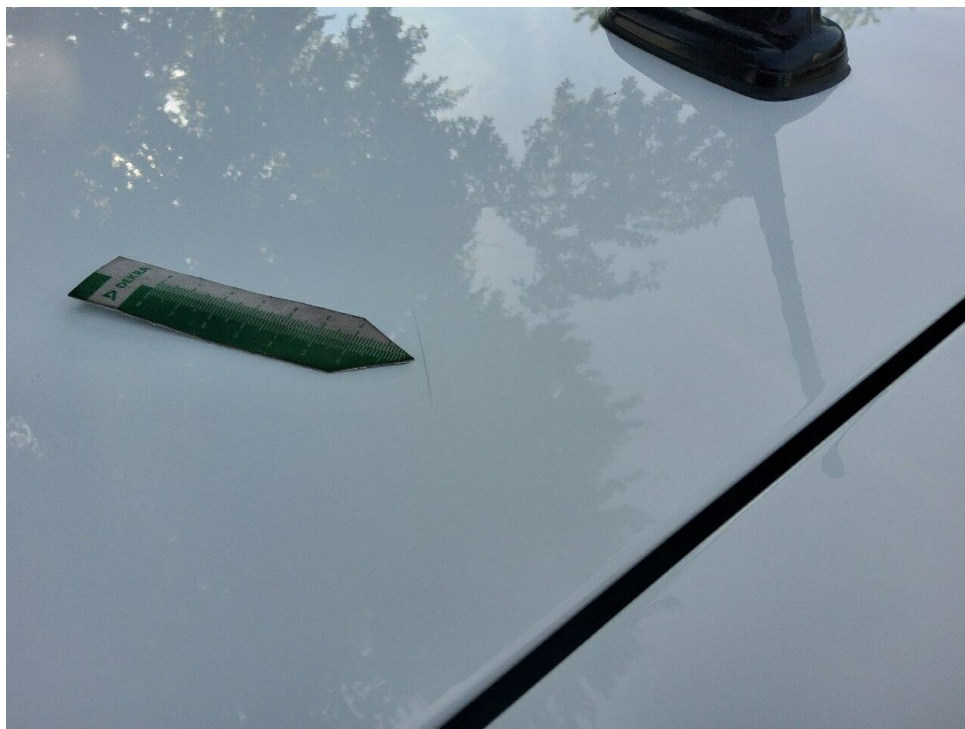
Bild 17 : Dach Steinschlag mit Korrosionsbildung und verschrammt
