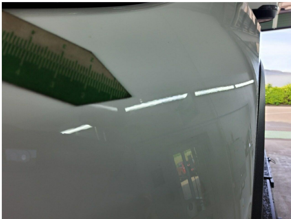
Bild 33 : Stoßfänger vorn Steinschläge
