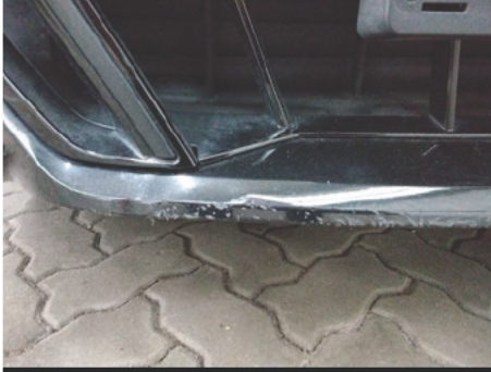
Stoßfänger oberhalb / Vorne / Delle
