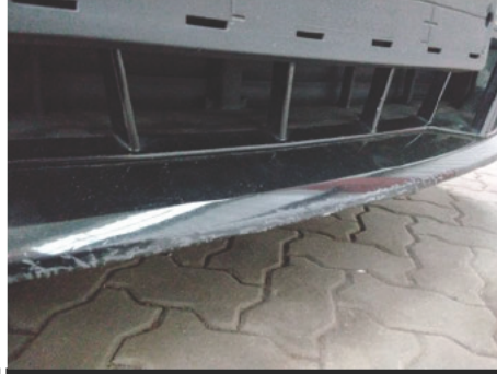
Stoßfänger oberhalb / Vorne / Delle
