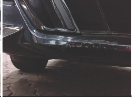
Stoßfänger oberhalb / Vorne / Delle
