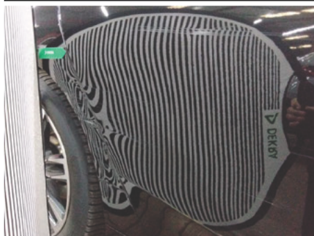
Tür / Hinten Rechts / Delle
