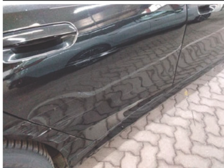
Tür / Hinten Rechts / Delle
