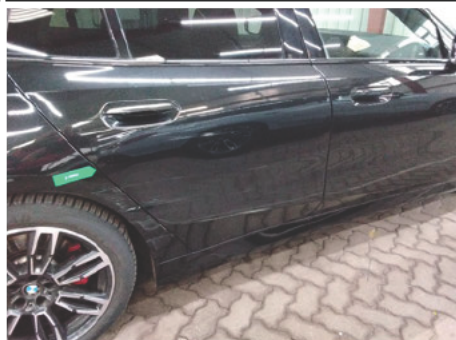
Tür / Hinten Rechts / Delle
