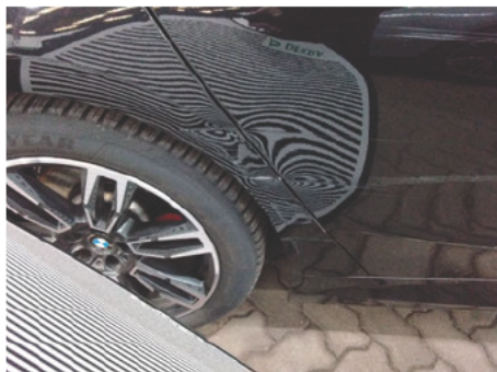
Seitenwand / Hinten Rechts / Delle
