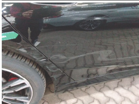
Tür / Hinten Rechts / Delle
