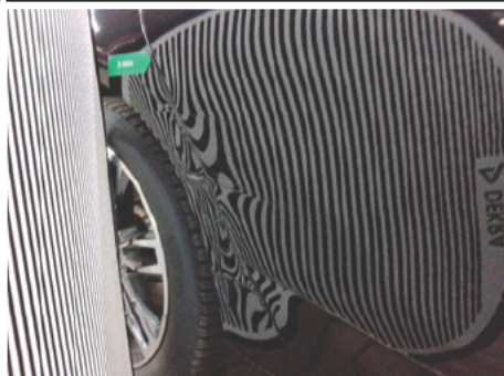
Tür / Hinten Rechts / Delle
