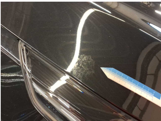
Damage 1: Bonnet: Bonnet (Vogelkotverätzung eingebrannt) - Paint defect - Cover / polish
