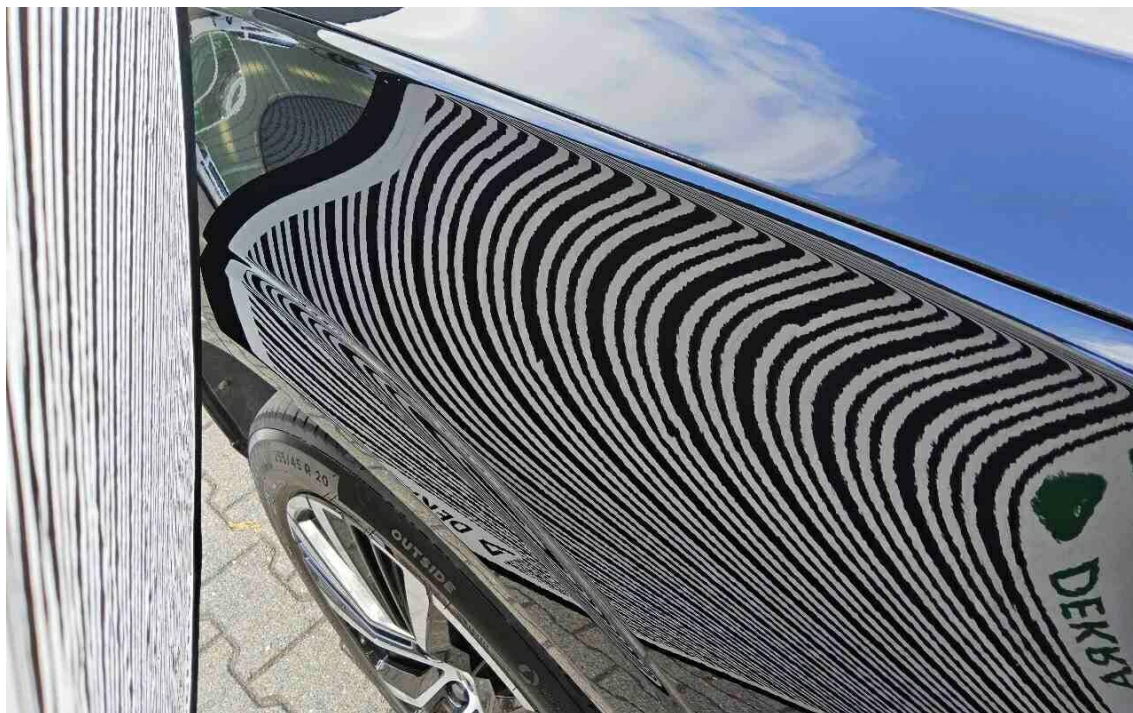
Bild 15 : Hagelschaden (bereits an Mobility gemeldet) Kotflügel links
