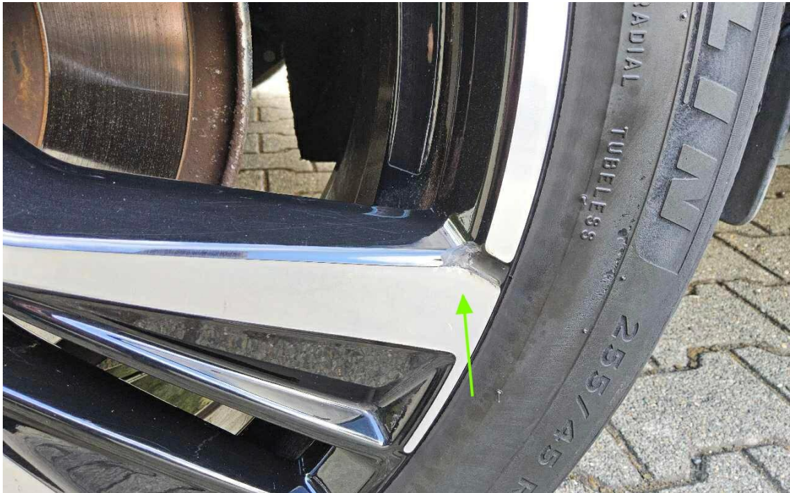
Bild 19 : Glanzgedrehte Felge hinten rechts, Lackplatzer
