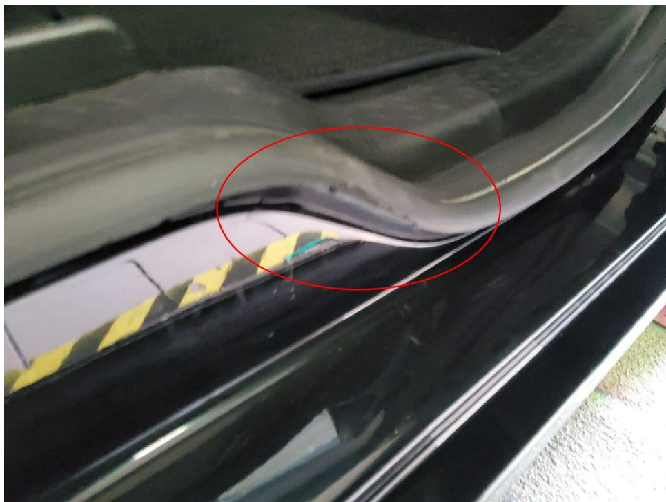
Bild 14 : Tüрдichtung vorne rechts zerkratzt
