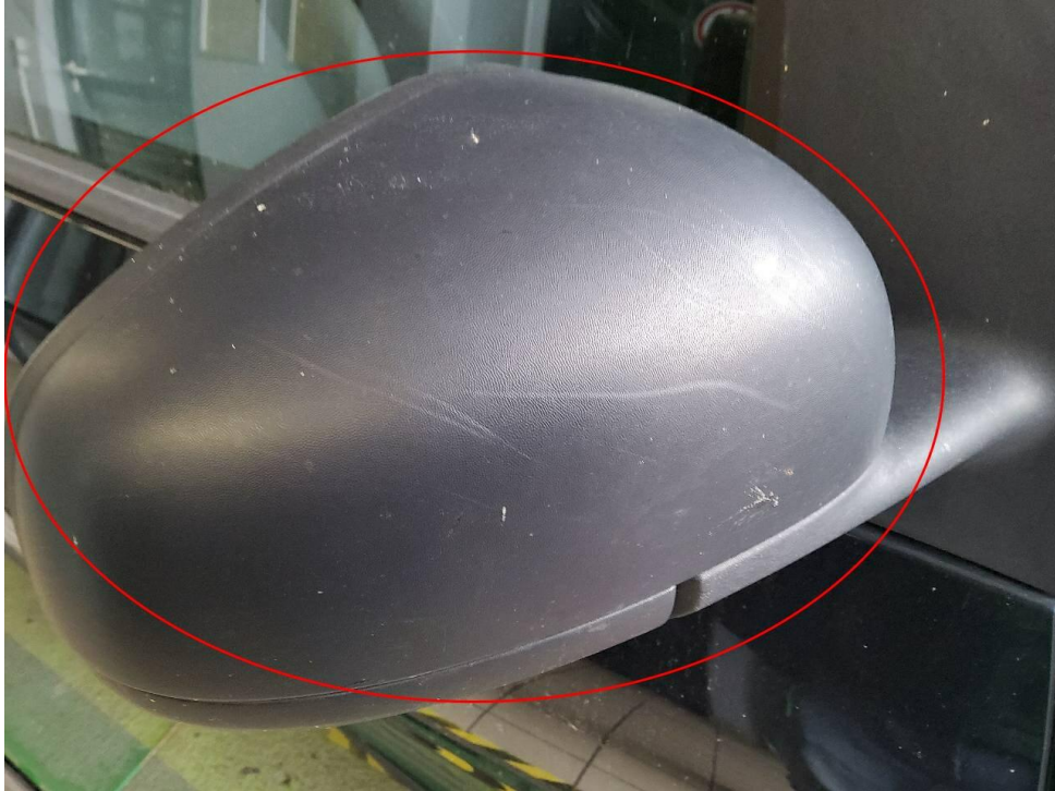
Bild 15 : Aussenspiegelkappe rechts zerkratzt
