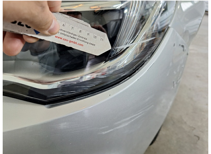
Scheinwerfer links: verschrammt (Foto 18)
