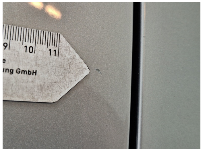
Motorhaube: Steinschlag (Foto 20)
