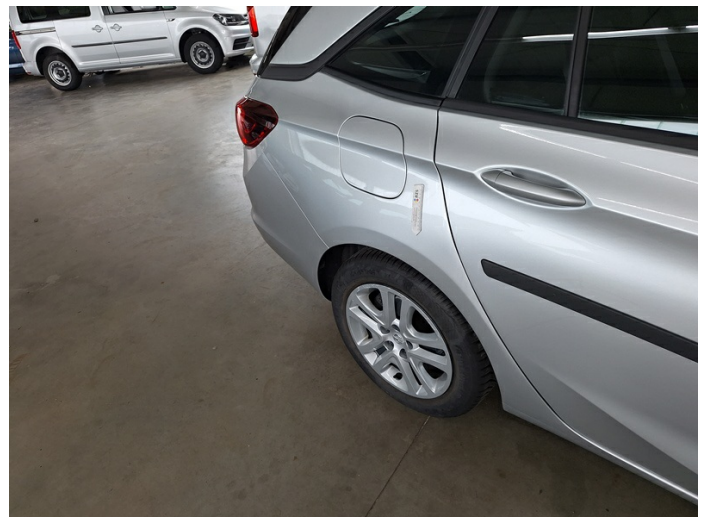
Seitenwand rechts: Lackierung nacharbeiten (Foto 40)
