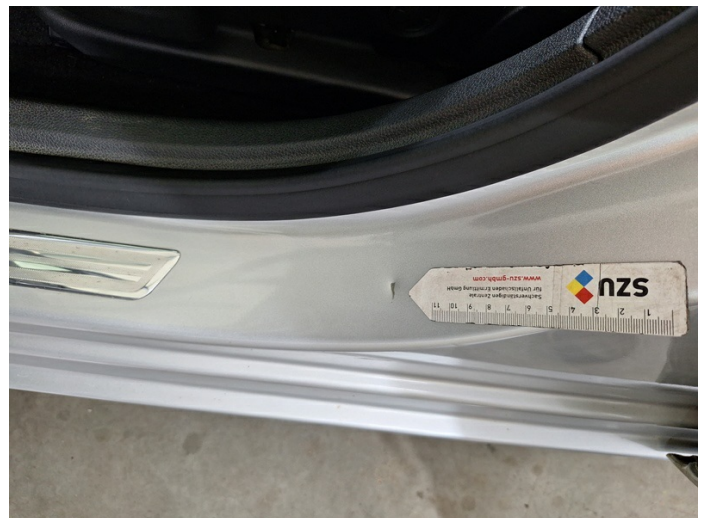
Einstieg vorne links: Delle mit Lackbeschädigung (Foto 12)
