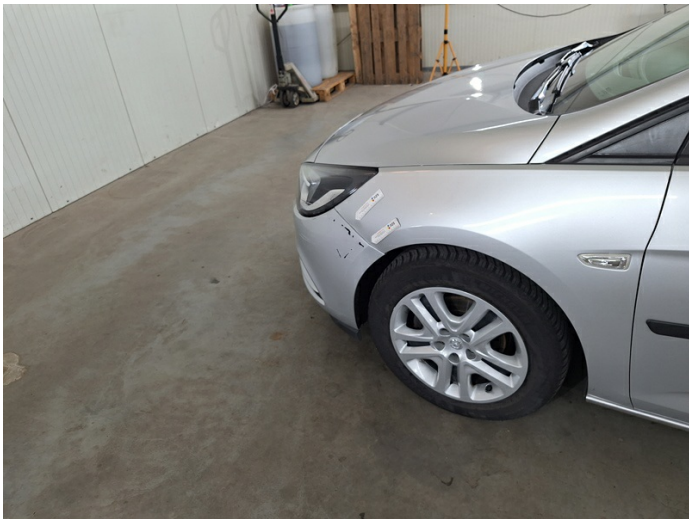
Kotflügel links: verformt (Foto 13)
