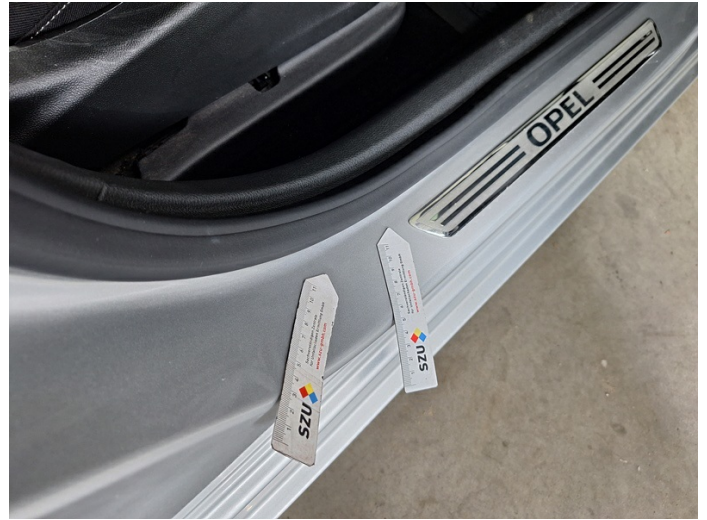
Einstieg vorne rechts: Dellen (Foto 34)
