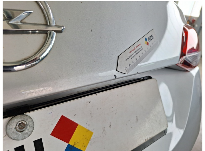
Heckklappe: Kratzer (Foto 44)
