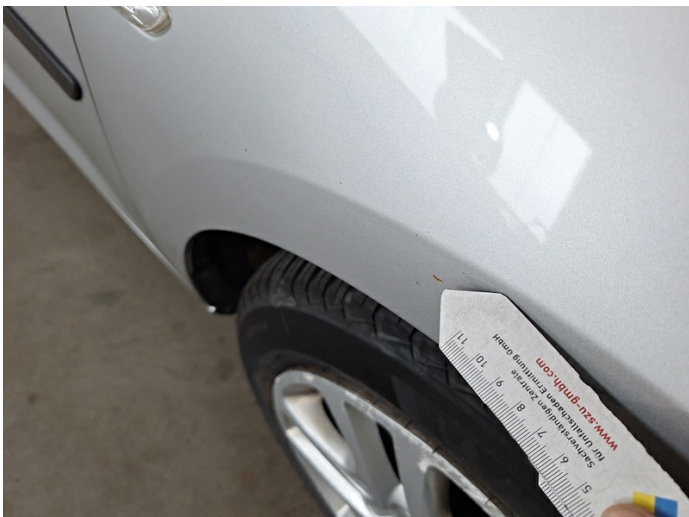
Fahrzeug außen: Flugrost (Foto 23)
