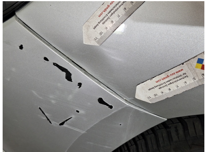
Kotflügel links: verformt (Foto 14)
