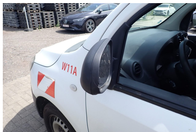
Beschädigung 6: Außenspiegel links: Abdeckkappe - gebrochen / gerissen - erneuern
