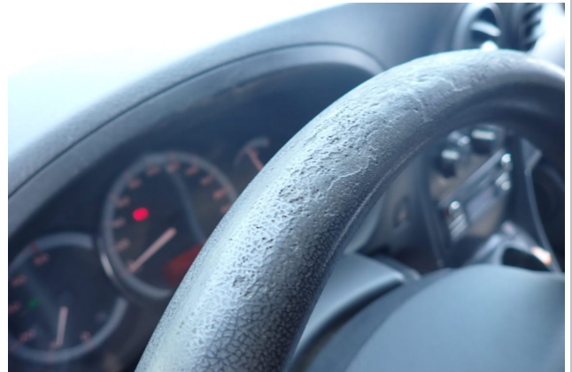
Gebrauchsspur 5: Lenkanlage: Lenkrad - Abrieb - kein Abzug
