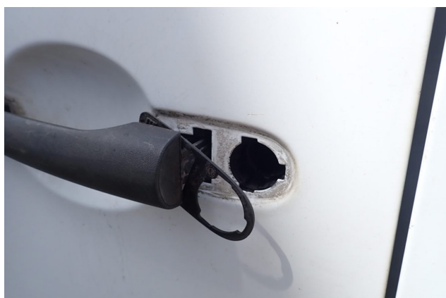
Beschädigung 5: Heckklappe/-tür: Schloss / Verriegelung - fehlt - erneuern
