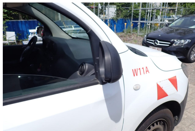
Beschädigung 7: Außenspiegel rechts: Abdeckkappe - gebrochen / gerissen - erneuern
