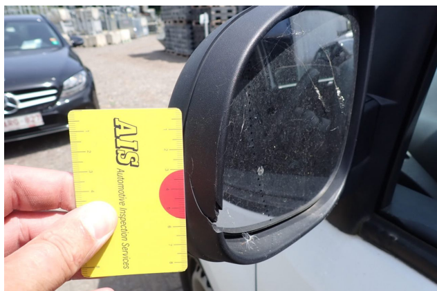
Beschädigung 6: Außenspiegel links: Abdeckkappe - gebrochen / gerissen - erneuern
