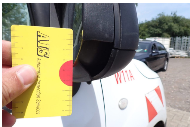
Beschädigung 7: Außenspiegel rechts: Abdeckkappe - gebrochen / gerissen - erneuern
