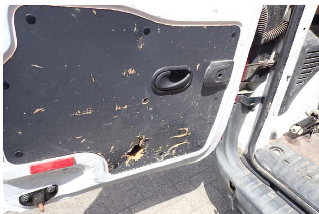
Beschädigung 4: Heckklappe/-tür: Verkl. Hecktür Hartfaser oben - gebrochen / gerissen - erneuern
