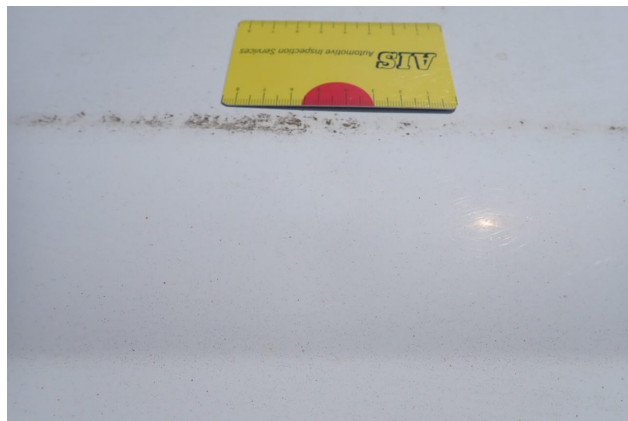
Gebrauchsspur 1: Fahrzeugdach: Dach - Delle(n) - kein Abzug
