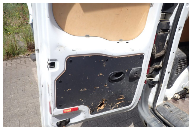
Beschädigung 8: Heckklappe/-tür: Hecktür links - Delle / Lackschaden - instandsetzen und lackieren
