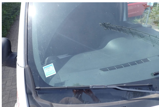
Beschädigung 3: Verglasung: Frontscheibe - Steinschlag - Smart Repair
