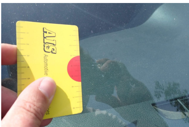
Beschädigung 3: Verglasung: Frontscheibe - Steinschlag - Smart Repair
