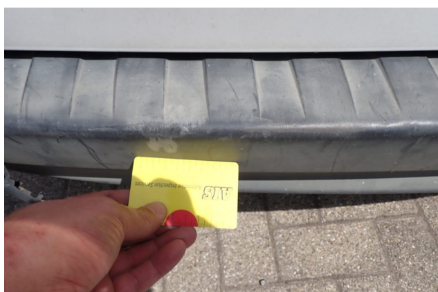
Gebrauchsspur 3: Stossfänger hinten: Stossfänger hinten (unlackiert) - verkratzt / verschürft - kein Abzug
