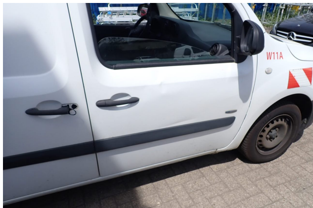
Beschädigung 9: Tür vorn rechts: Tür - Delle / Lackschaden - instandsetzen und lackieren
