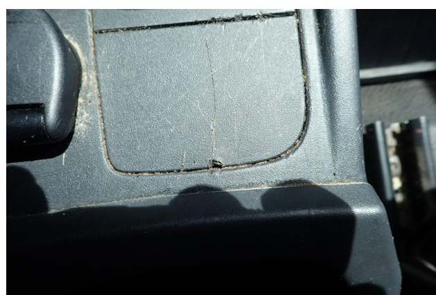
Gebrauchsspur 4: Instrumententafel: Mittelkonsole vorn - Kratzer - kein Abzug
