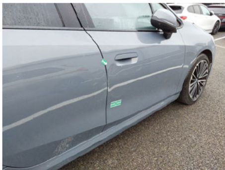
Porte / Avant Droit / Enfoncement
