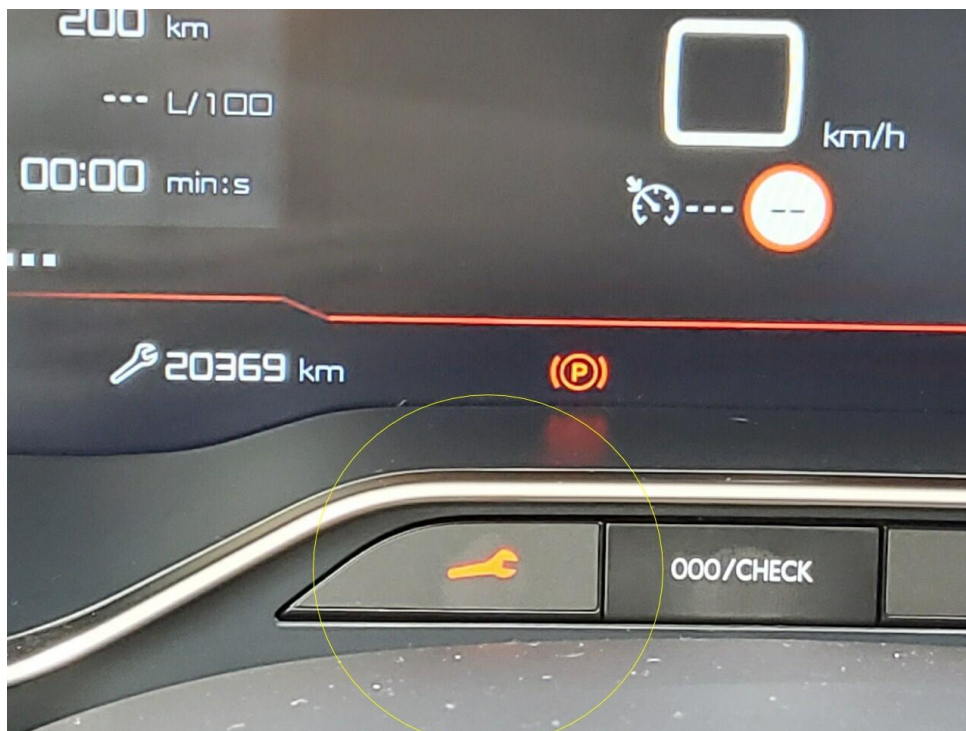
Bild 11 : Inspektin mit Ölwechsel überfällig
