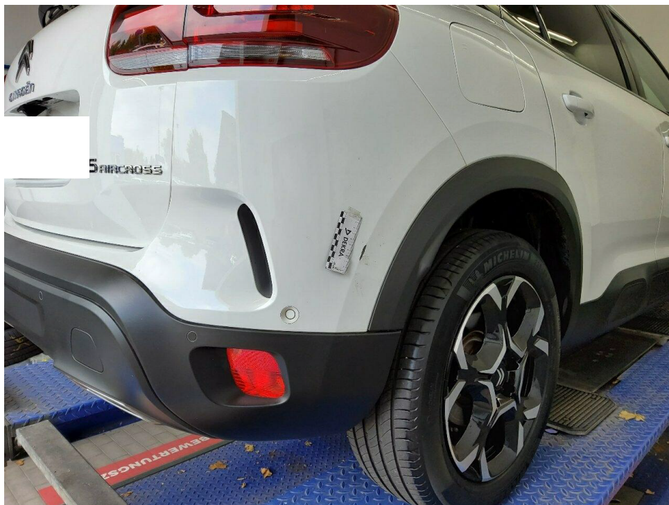
Bild 13 : Unfallschaden hinten rechts
