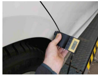
Lackstärke Seitenwand hinten rechts
