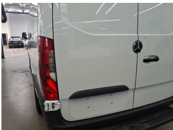
Beschädigung #3: Heckklappe/-tür: Schriftzug Hecktür links - fehlt - erneuern
