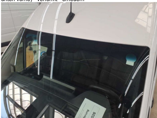
Beschädigung #17: Verglasung: Frontscheibe mit Spurhalteassistent - gebrochen / gerissen - erneuern
