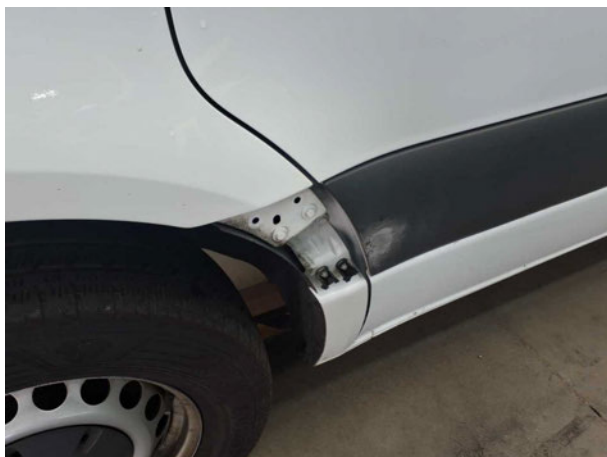
Beschädigung #1: Kotflügel links: Zierleiste, -gitter - fehlt - erneuern
