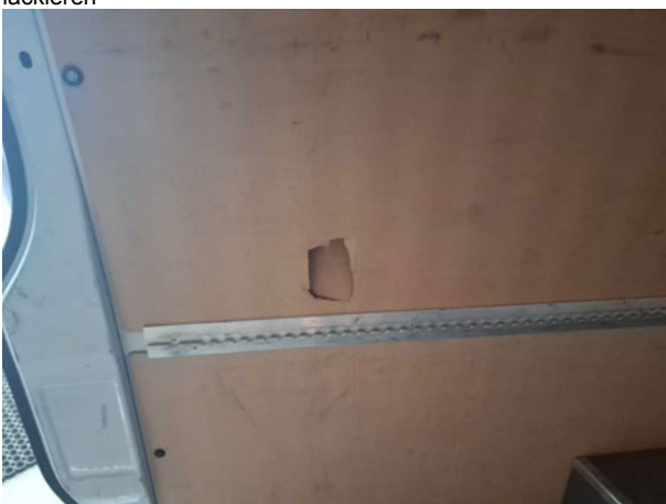
Beschädigung #13: Seitenwand rechts: Innenverkleidung (Sperrholz Mitte) - gebrochen / gerissen - erneuern
