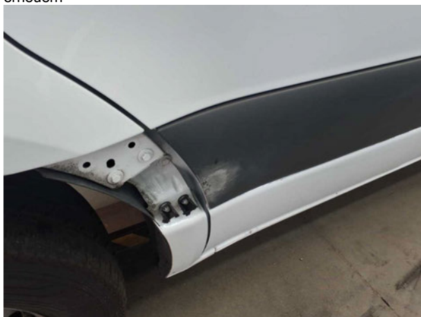
Beschädigung #5: Tür vorn links: Zierleiste unten - verkratzt / verschürft - erneuern
