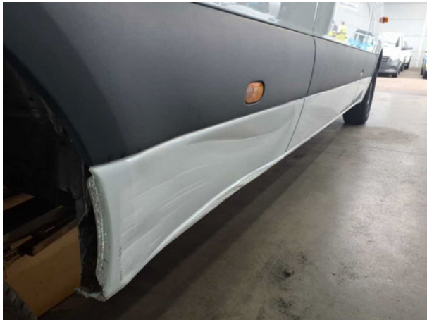
Beschädigung #16: Seitenwand rechts: Seitenwand (Beplankung unten vorne) - verformt - erneuern
