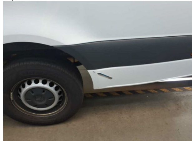
Beschädigung #9: Seitenwand links: Seitenwand (Beplankung unten hinten) - Delle / Lackschaden - Smart Repair
