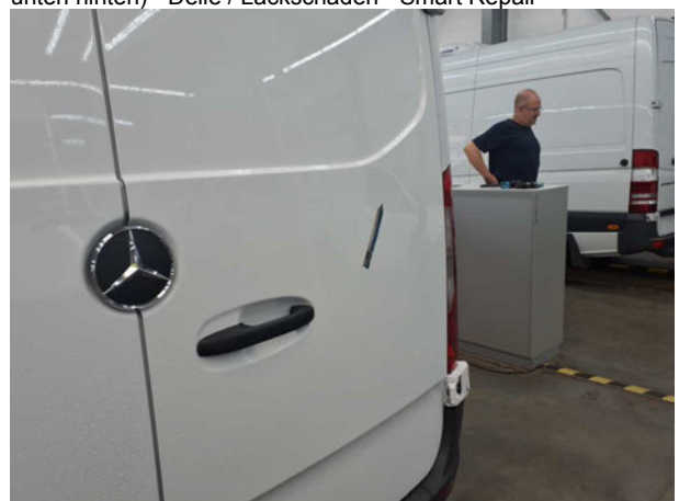
Beschädigung #10: Heckklappe/-tür: Hecktür rechts - Delle(n) - Smart Repair
