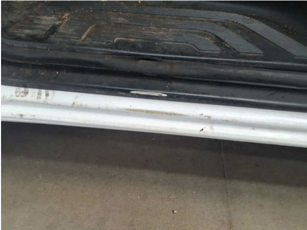
Beschädigung #11: Schweller links: Einstieg - verkratzt / verschürft - lackieren
