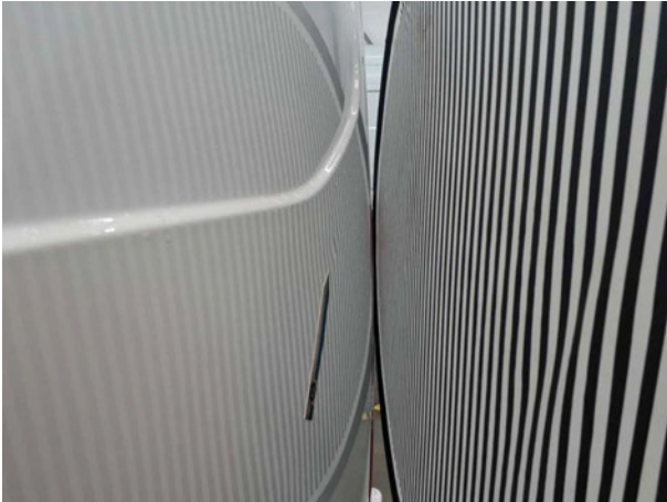
Beschädigung #10: Heckklappe/-tür: Hecktür rechts - Delle(n) - Smart Repair
