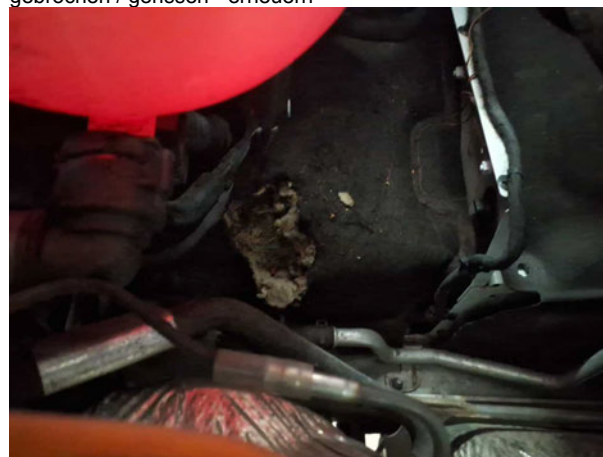
Beschädigung #6: Kotflügel rechts: Innenkotflügel - Marderschaden - erneuern
