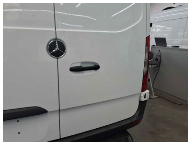
Beschädigung #2: Heckklappe/-tür: Schriftzug Hecktür rechts - fehlt - erneuern
