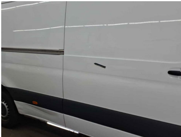
Beschädigung #15: Schiebetür rechts: Schiebetür - Delle(n) - instandsetzen und lackieren
