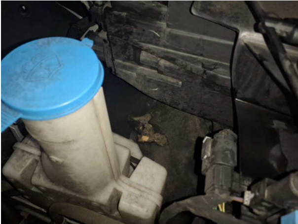
Beschädigung #7: Kotflügel links: Innenkotflügel - Marderschaden - erneuern
