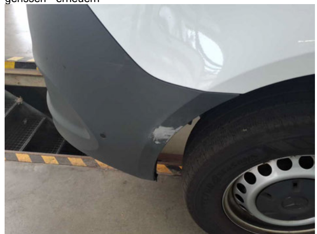
Beschädigung #14: Stossfänger vorn: Stossfänger mit Parktroni... verkratzt / verschürft - erneuern
