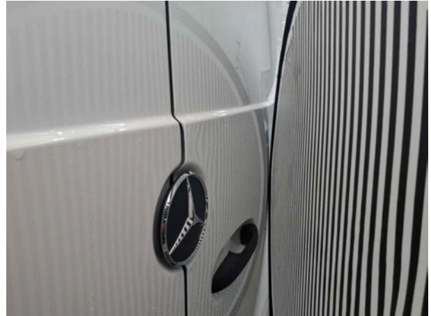
Beschädigung #10: Heckklappe/-tür: Hecktür rechts - Delle(n) - Smart Repair
