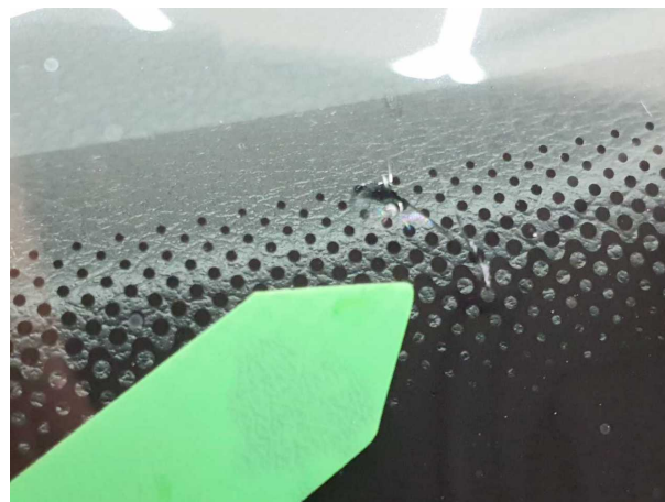
Beschädigung #8: Verglasung: Frontscheibe - Steinschlag - erneuern
