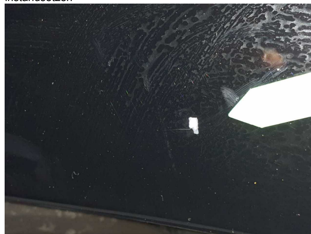
Beschädigung #5: Seitenwand links: Einstieg - Kratzer - Smart Repair
