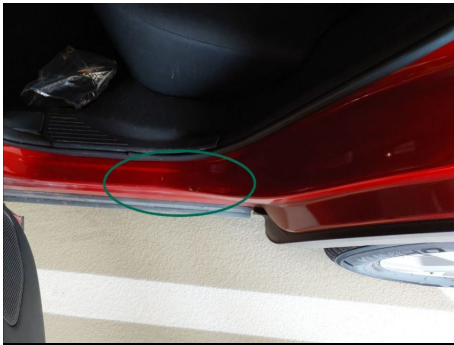
Türeinstieg / Hinten Links / Kratzer
