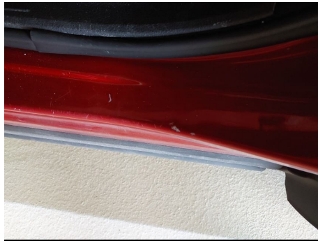
Türeinstieg / Hinten Links / Kratzer
