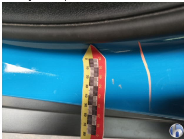
2. Türeinstieg Vorne - Links Kratzer - Smart Repair
