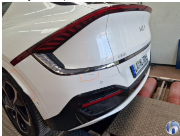
5. Stoßfänger Hinten Beschädigt - Smart Repair
