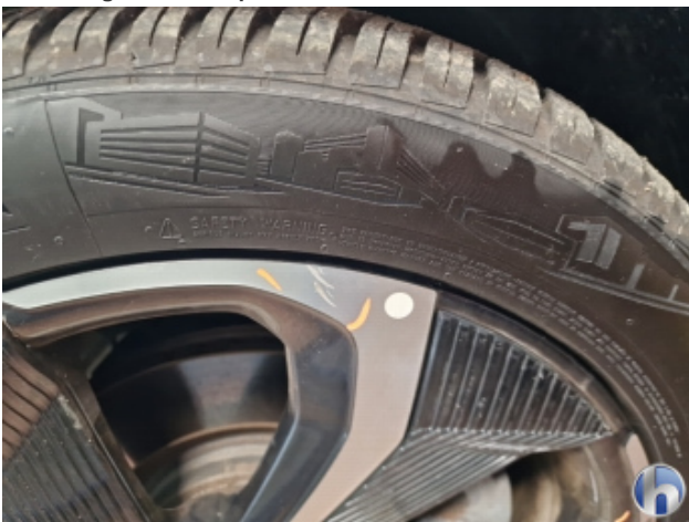
6. Felge Vorne - Rechts Beschädigt - Smart Repair
