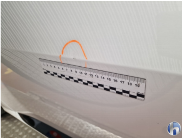
1. Tür Vorne - Links Delle - Sanft Instandsetzen
