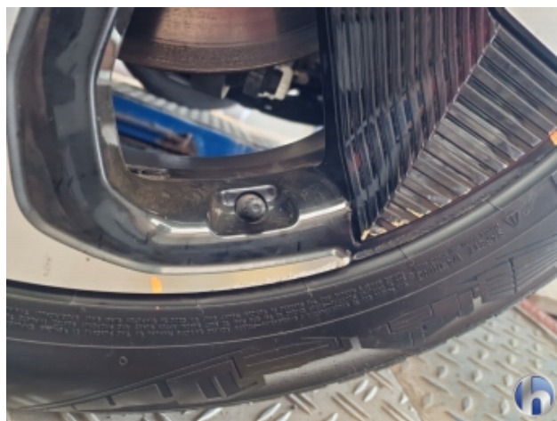
4. Felge Hinten - Links Beschädigt - Smart Repair
