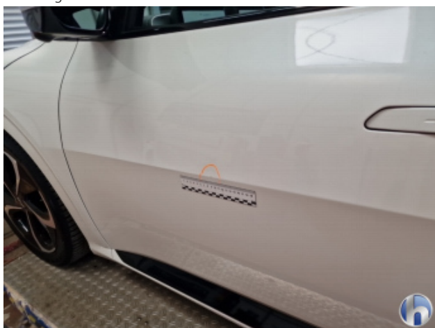
1. Tür Vorne - Links Delle - Sanft Instandsetzen
