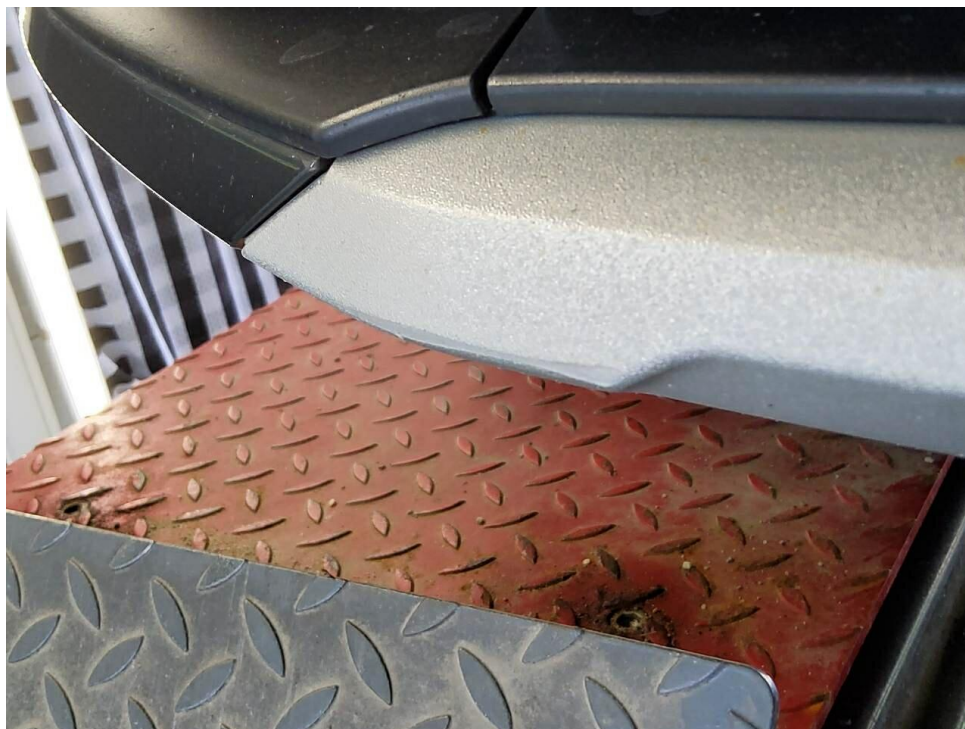
Bild 5 : Frontspoiler verschrammt und deformiert
