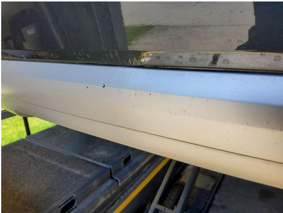
Bild 8 : Stoßfänger hinten Unterteil deformiert
