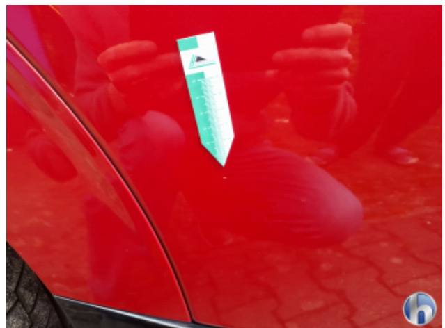
2. Tür Hinten - Rechts Gebrauchsspuren - Ohne Reparatur
