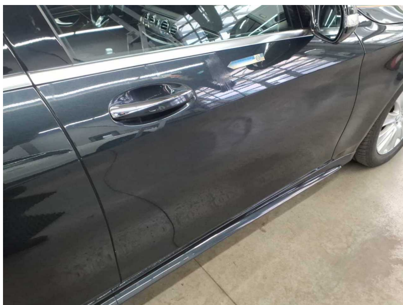
Beschädigung #20: Tür vorn rechts: Tür (Einätzungen) - Lackmangel - lackieren
