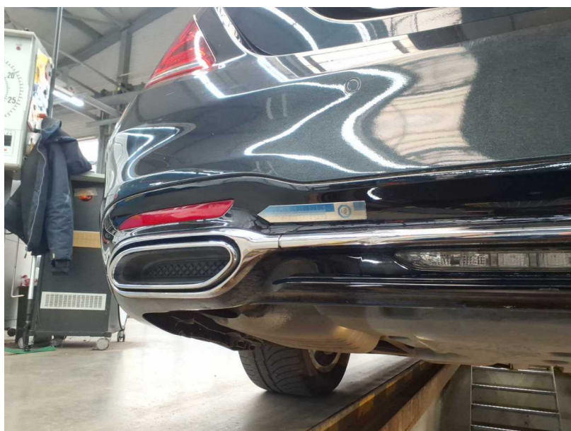
Beschädigung #9: Verkleidungen/Abdeckungen: Verkleidungen/Abdeckungen (Stoßfänger hinten unten) - Lackmangel - lackieren
