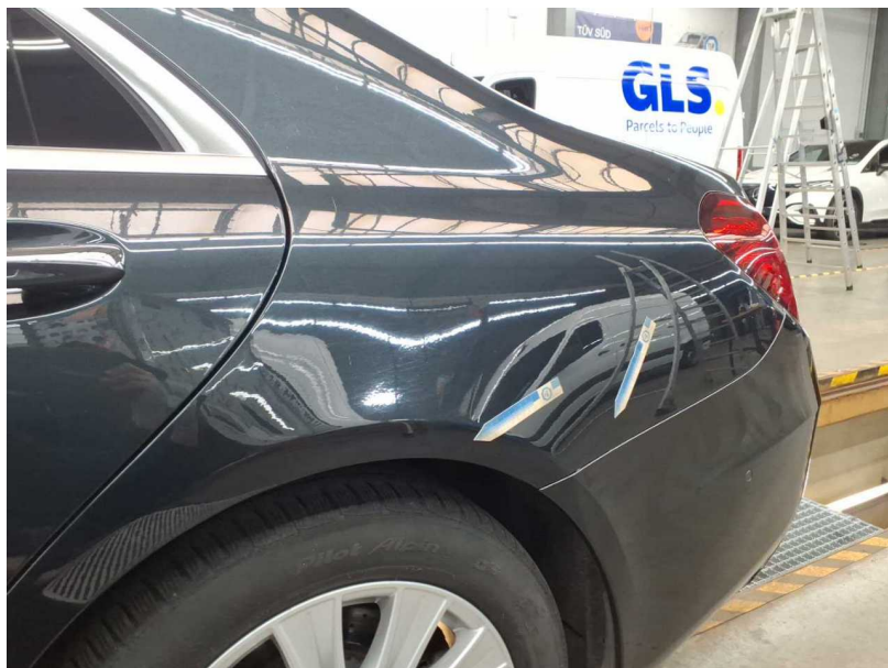
Beschädigung #22: Seitenwand links: Seitenwand - Delle(n) - instandsetzen und lackieren
