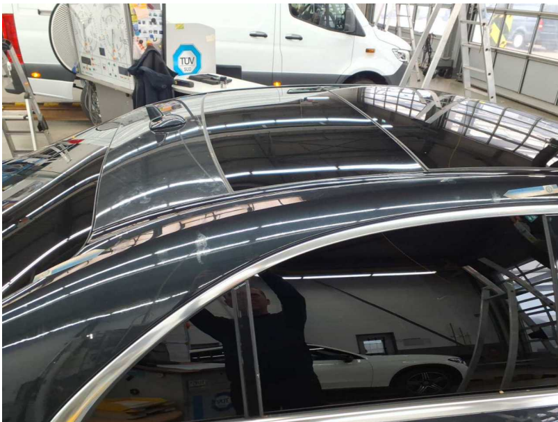
Beschädigung #14: Fahrzeugdach: Dachholm rechts (Einätzungen) - Lackmangel - lackieren
