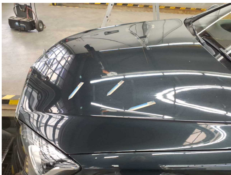
Beschädigung #25: Motorhaube: Motorhaube (Schleifspuren) - nicht fachgerecht instandgesetzt - instandsetzen und lackieren
