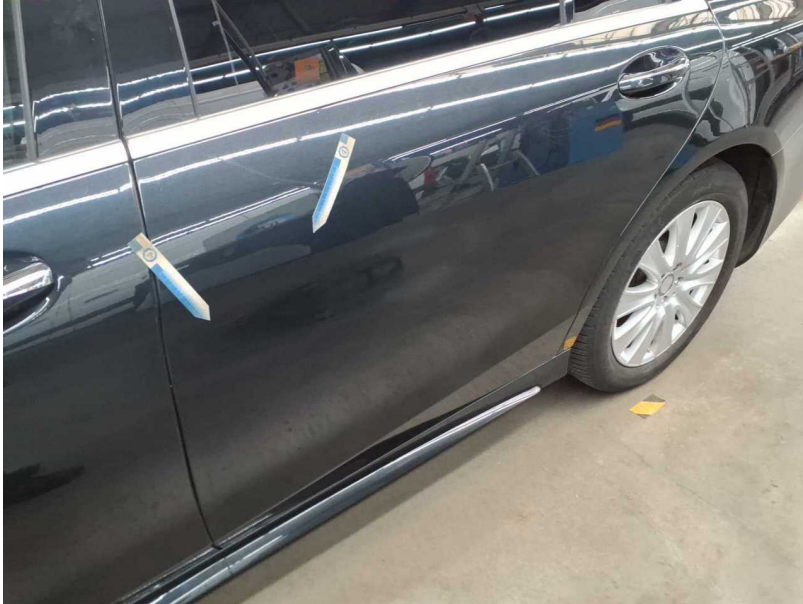
Beschädigung #24: Tür hinten links: Tür - Delle / Lackschaden - instandsetzen und lackieren
