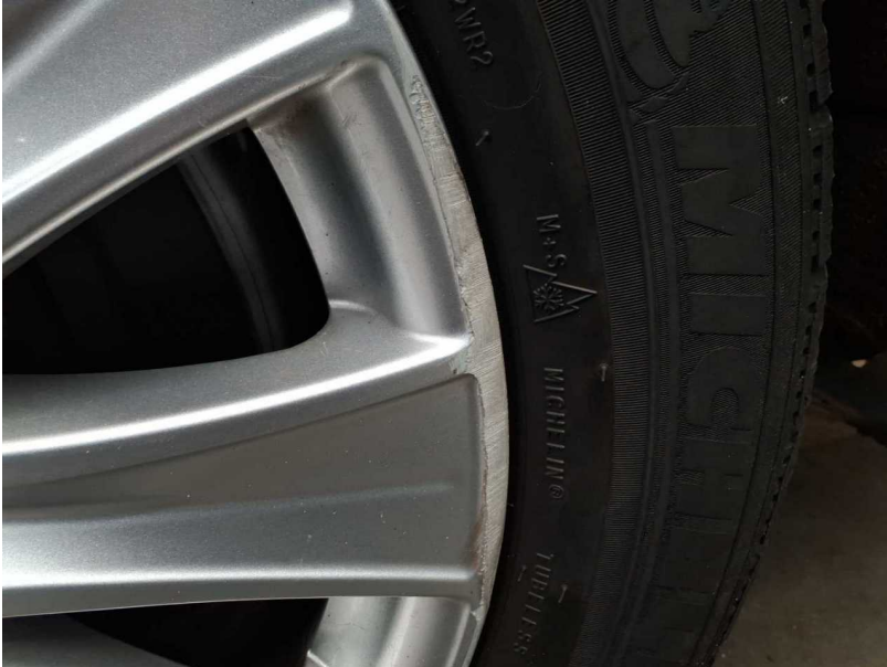
Beschädigung #2: Rad/Reifen: Leichtmetallfelge hinten links (Materialabtrag) - verkratzt / verschürft - kein Abzug
