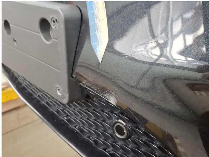
Beschädigung #27: Stossfänger vorn: Stossfänger mit Parktronic (+ Anbauteile fehlen / gebrochen) - verformt - erneuern
