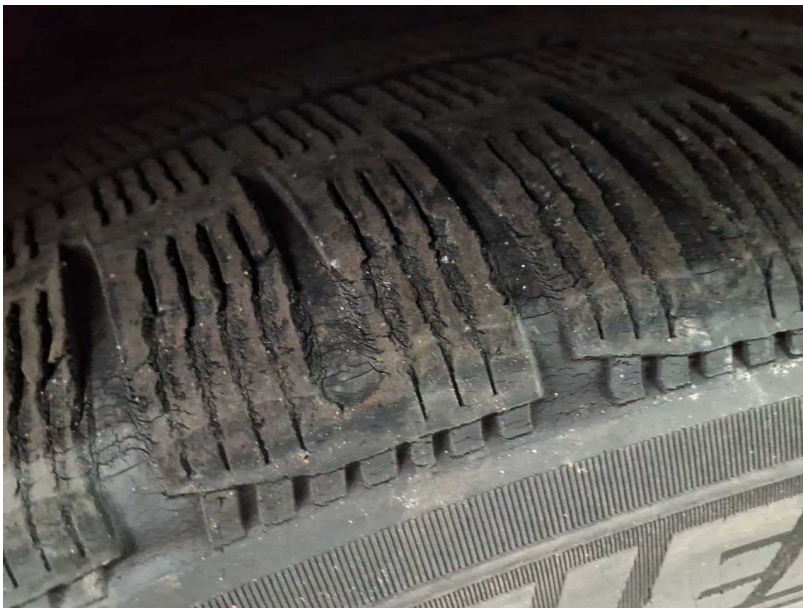
Beschädigung #4: Rad/Reifen: Reifen vorn links - porös / rissig - kein Abzug
