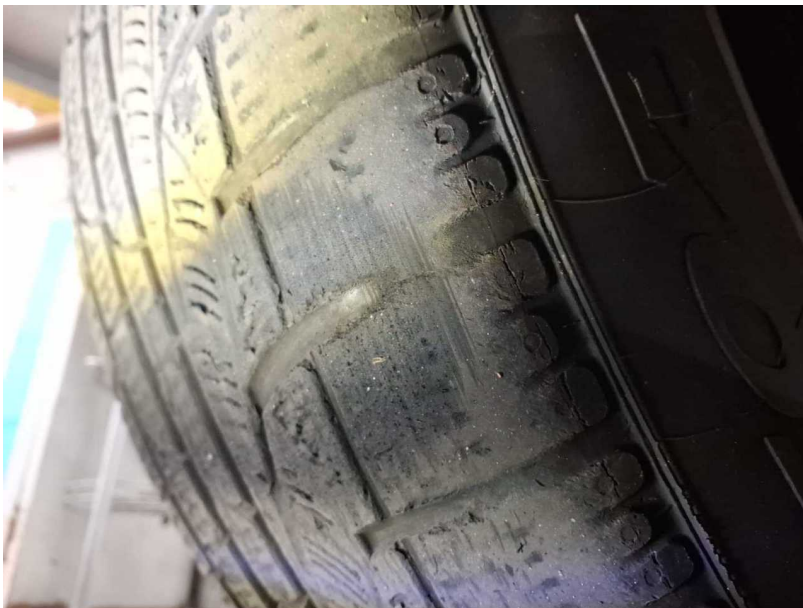
Beschädigung #5: Rad/Reifen: Reifen hinten rechts - verschlissen - kein Abzug
