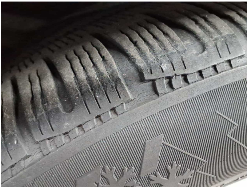
Beschädigung #3: Rad/Reifen: Reifen hinten links - porös / rissig - kein Abzug
