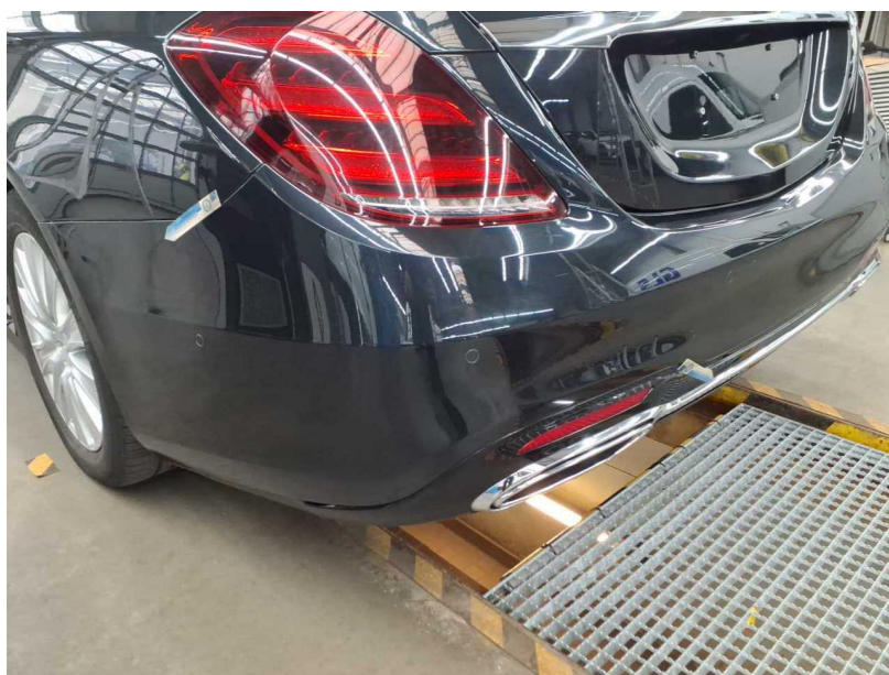
Beschädigung #26: Stossfänger hinten: Stossfänger mit Parktronic (+ Anbauteile - Kostenausweitung möglich) - verformt - erneuern
