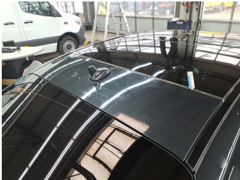
Beschädigung #13: Fahrzeugdach: Dach (Einätzungen) - Lackmangel - lackieren
