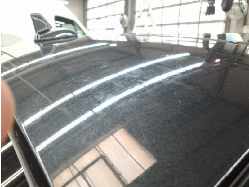
Beschädigung #13: Fahrzeugdach: Dach (Einätzungen) - Lackmangel - lackieren
