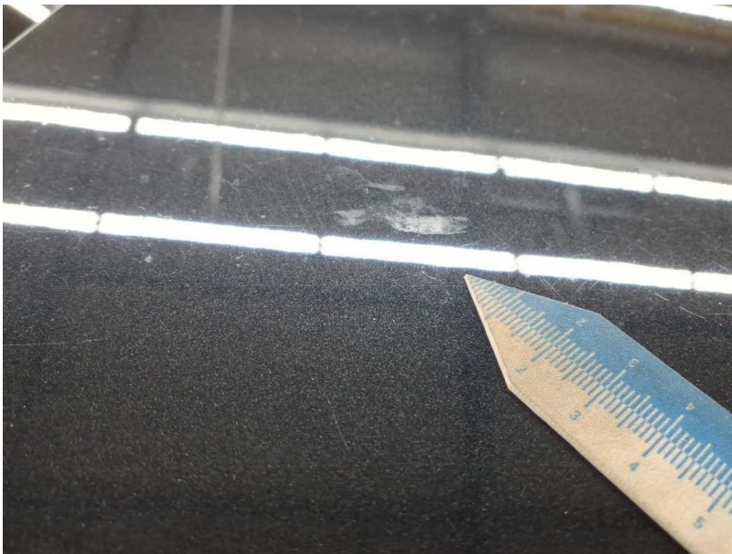
Beschädigung #21: Heckklappe/-tür: Heckklappe (Einätzungen) - Lackmangel - lackieren
