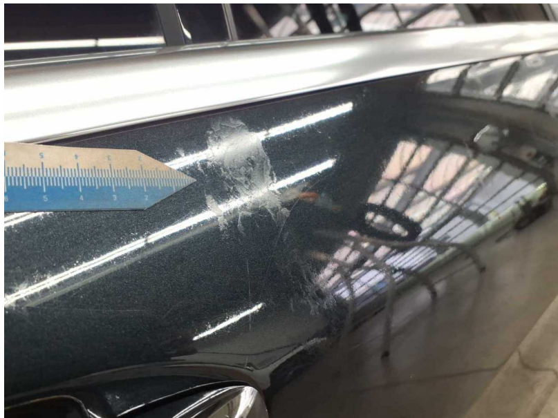
Beschädigung #19: Tür hinten rechts: Tür (+ Einätzungen) - Kratzer - lackieren
