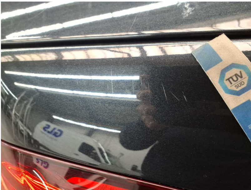
Beschädigung #23: Seitenwand rechts: Seitenwand (Schleifspuren + Lackeinschlüsse + Einätzungen) - nicht fachgerecht instandgesetzt - instandsetzen und lackieren
