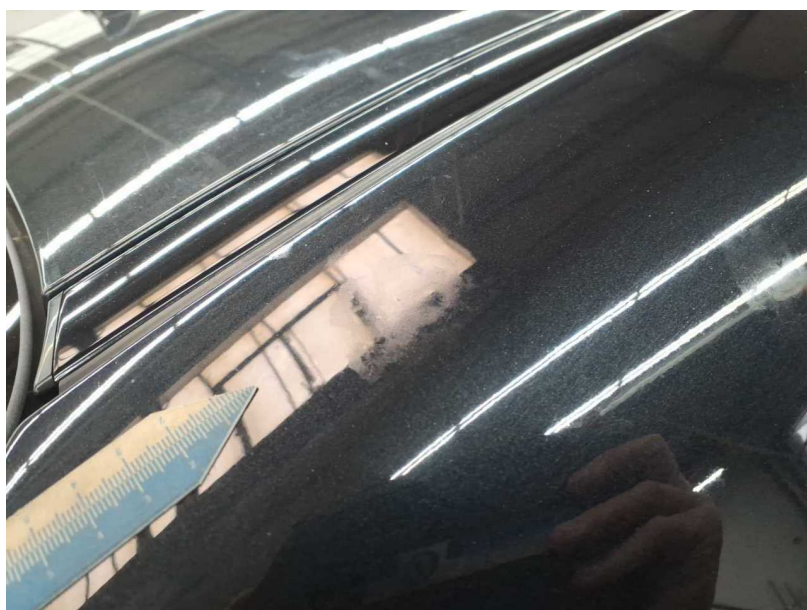
Beschädigung #14: Fahrzeugdach: Dachholm rechts (Einätzungen) - Lackmangel - lackieren
