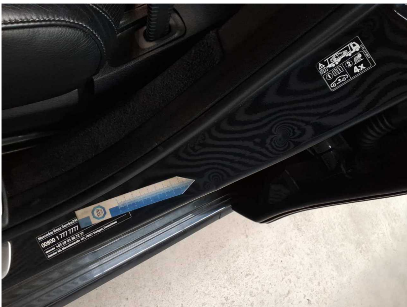
Beschädigung #16: Schweller links: Einstieg - Delle(n) - instandsetzen und lackieren
