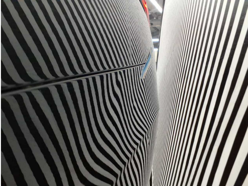
Beschädigung #26: Stossfänger hinten: Stossfänger mit Parktronic (+ Anbauteile - Kostenausweitung möglich) - verformt - erneuern
