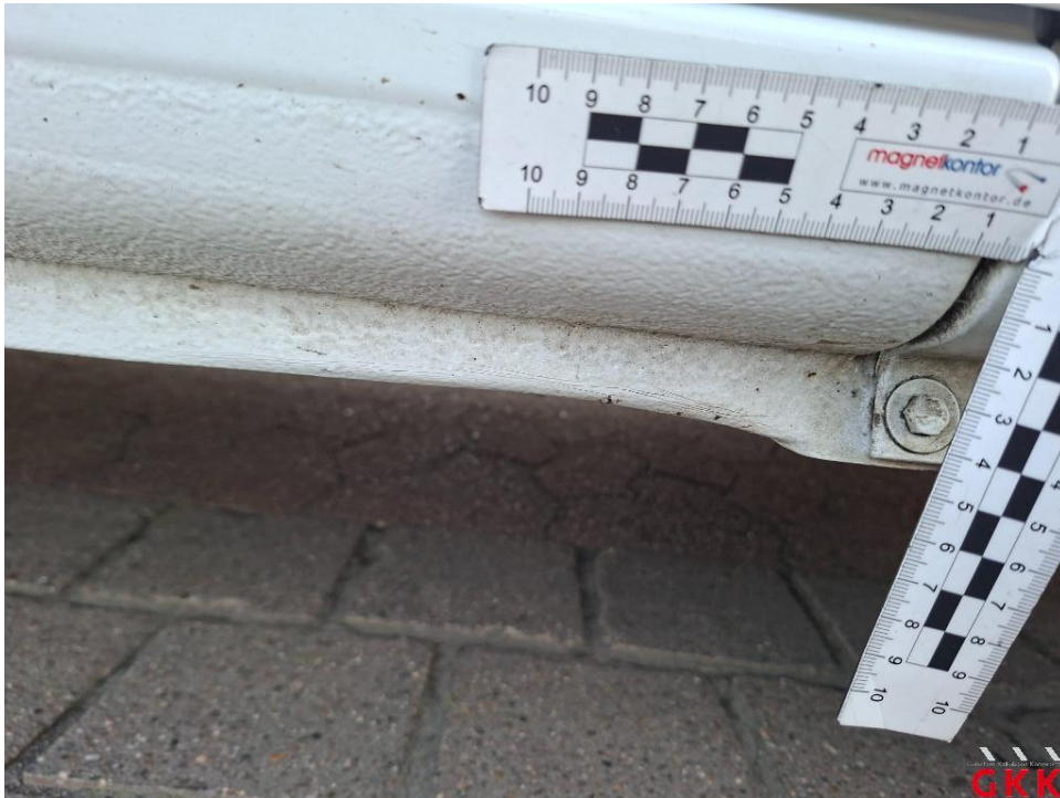
Bild 18. Schweller rechts, beschädigt, instand setzen - lackieren
