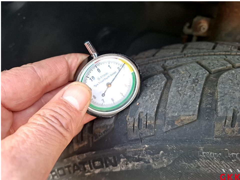
Bild 16. Reifen, vorne rechts, Untermaß, ersetzen
