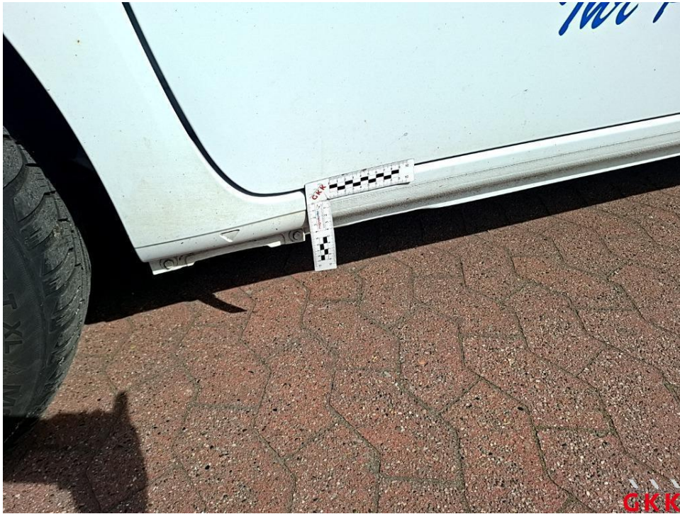
Bild 19. Schweller links, beschädigt, instand setzen - lackieren
