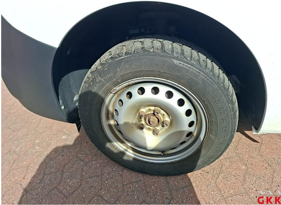
Bild 21. Reifen, vorne links, Untermaß, ersetzen
