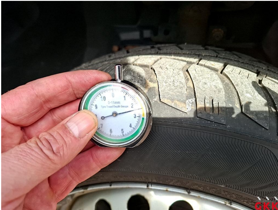
Bild 22. Reifen, vorne links, Untermaß, ersetzen
