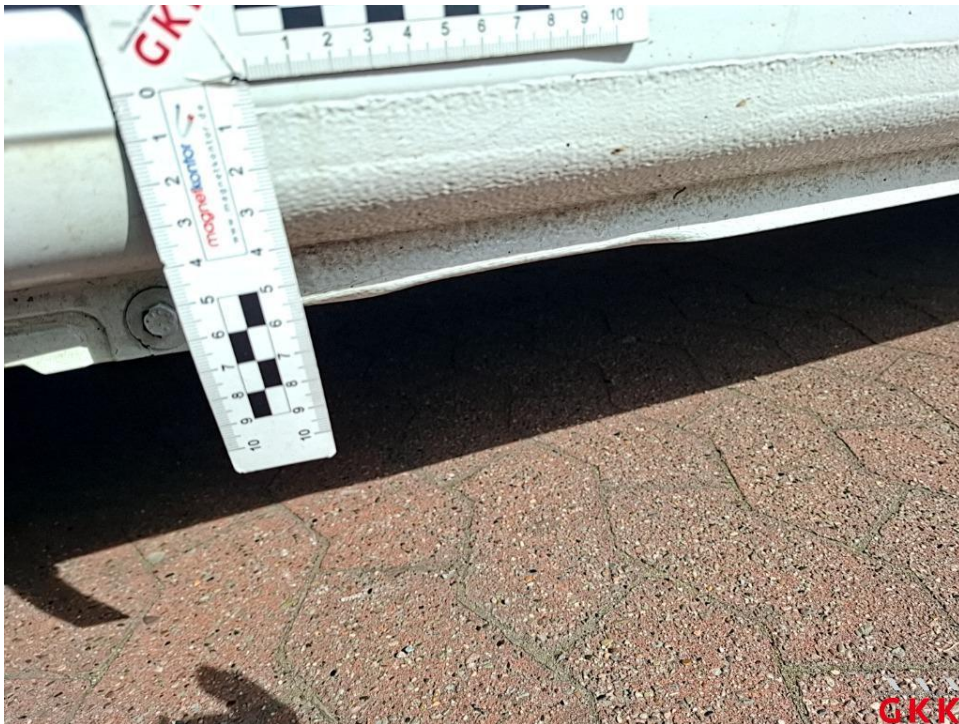
Bild 20. Schweller links, beschädigt, instand setzen - lackieren
