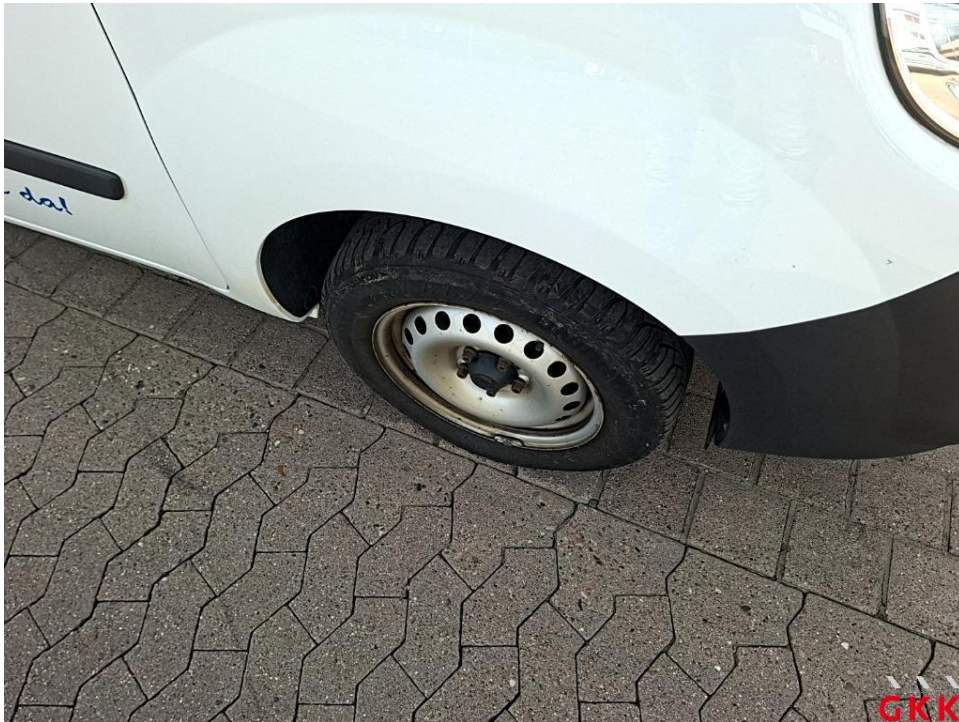
Bild 15. Reifen, vorne rechts, Untermaß, ersetzen
