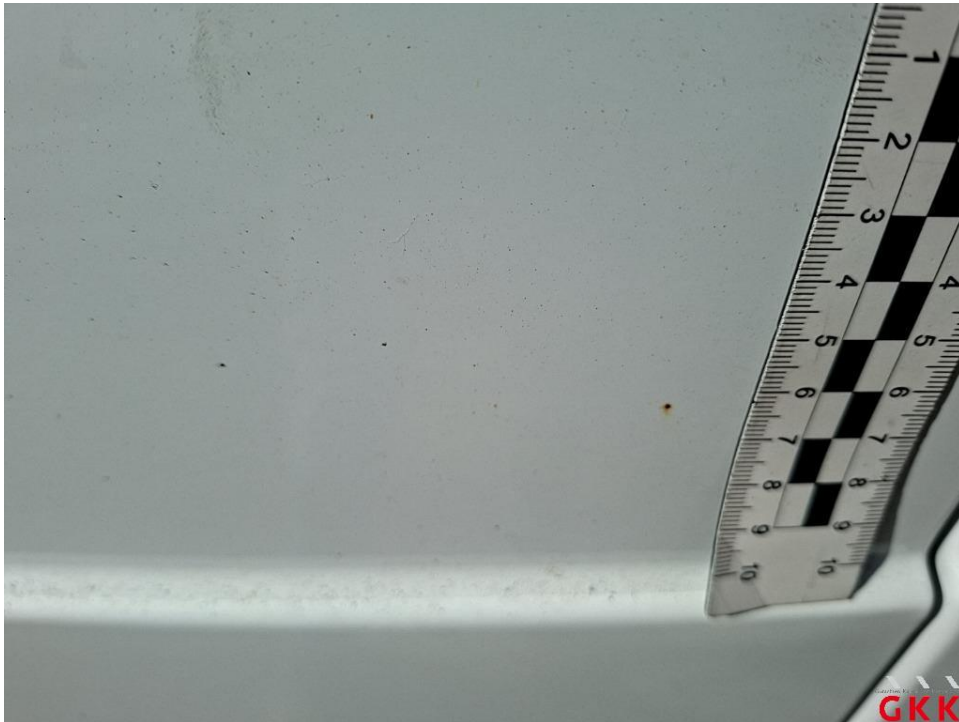
Bild 25. Fahrzeug, außen, Industriestaubhaftung / Flugrost, aufbereiten
