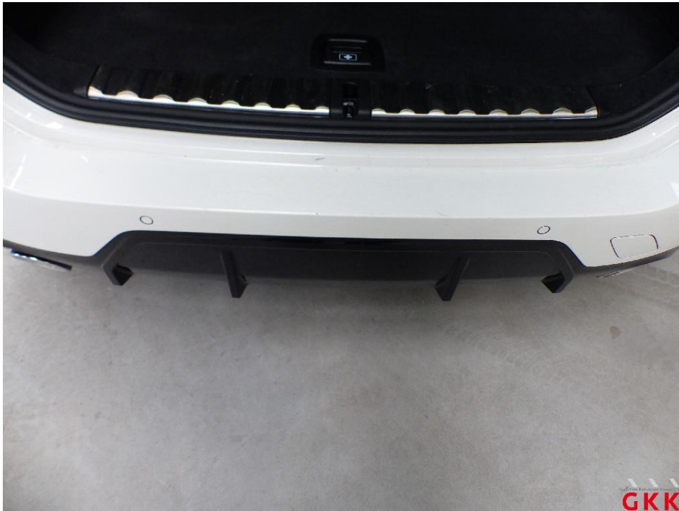
Bild 20 Stoßfänger hinten, Verkleidung -lackiert-, verkratzt, lackieren
