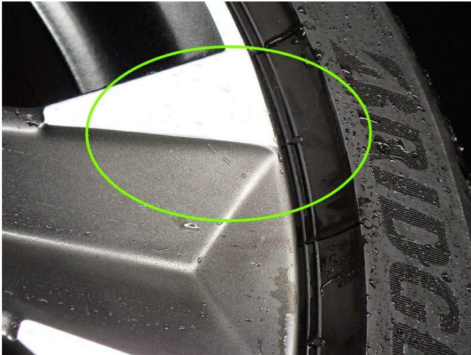
Bild 20 : Felge VL (glanzgedreht) instandgesetzt, restreparaturspuren sichtbar
