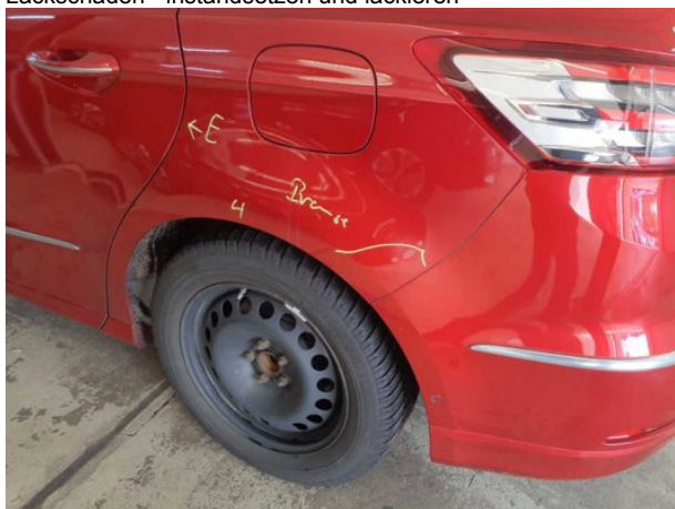
Beschädigung #15: Seitenwand links: Seitenwand - Kratzer - lackieren
