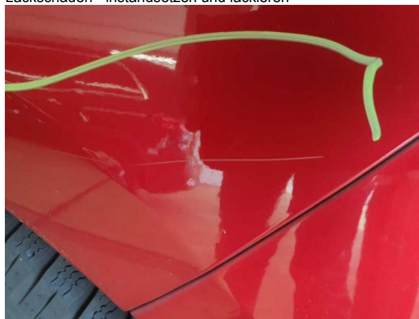
Beschädigung #15: Seitenwand links: Seitenwand - Kratzer - lackieren
