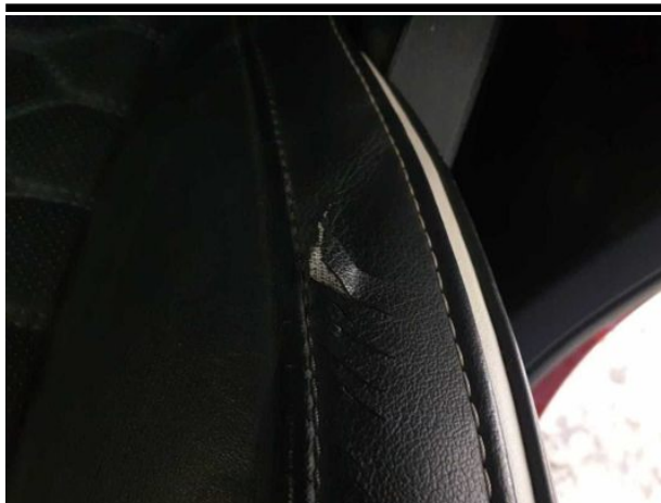
Beschädigung #9: Sitz vorn: Sitzbezug links - gebrochen / gerissen - erneuern
