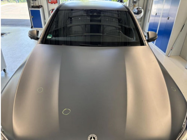
Motorhaube - verdellt / verkratzt - instandsetzen und lackieren
