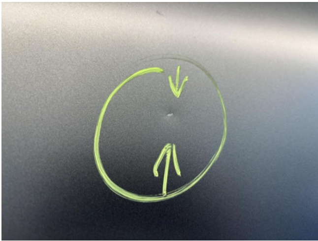
Tür vorne links - verdellt / verkratzt - instandsetzen und lackieren
