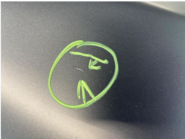
Motorhaube - verdellt / verkratzt - instandsetzen und lackieren
