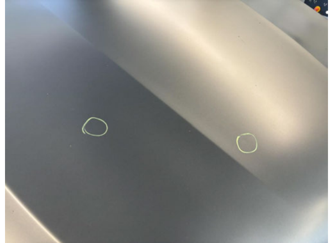
Motorhaube - verdellt / verkratzt - instandsetzen und lackieren
