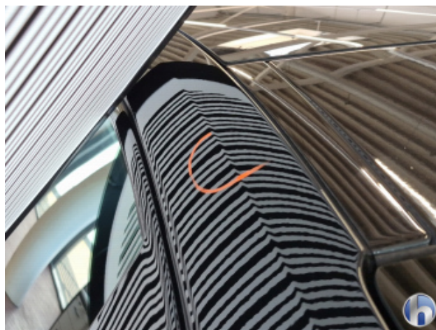
1. Dachrahmen - Links Gebrauchsspuren - Ohne Reparatur
