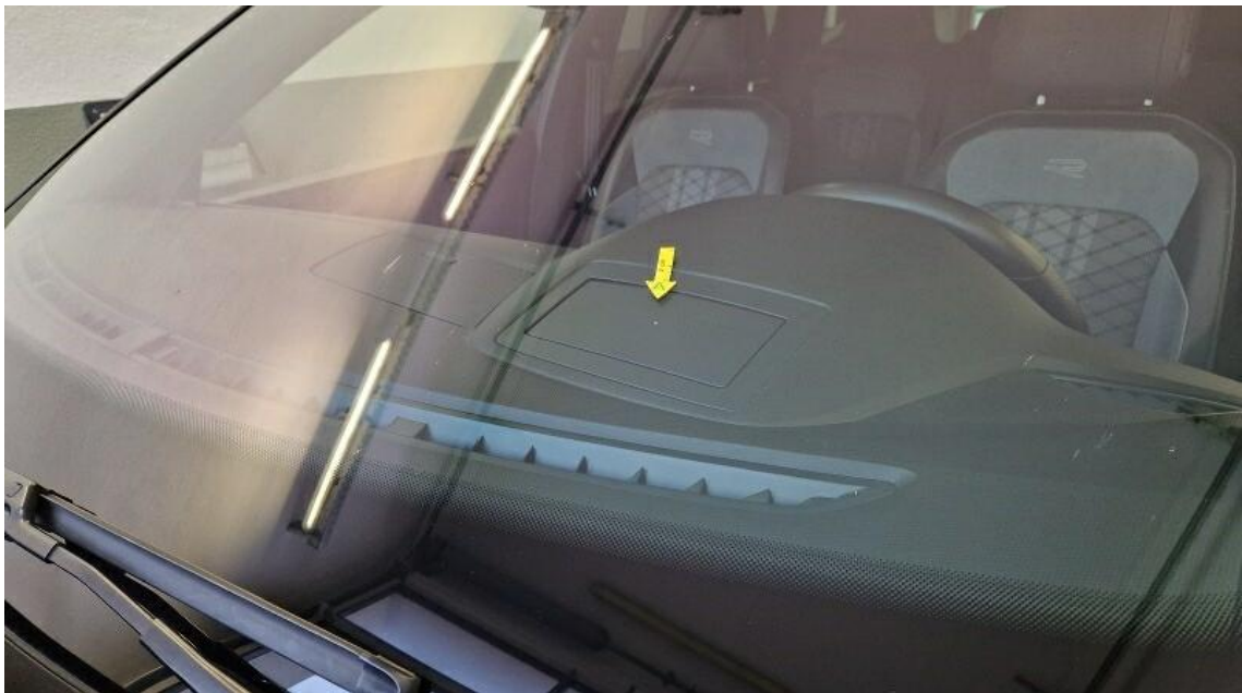
Bild 14 : Leichte Steinschläge im Frontbereich
