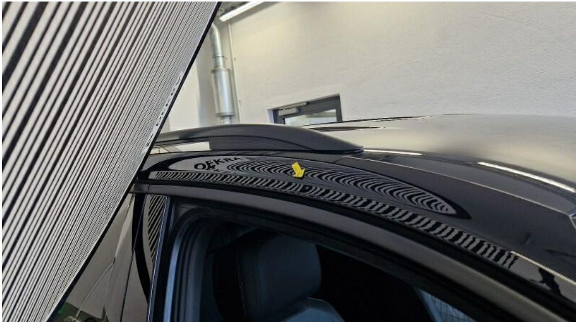
Bild 13 : Dachrahmen rechts, eingedellt, drücken
