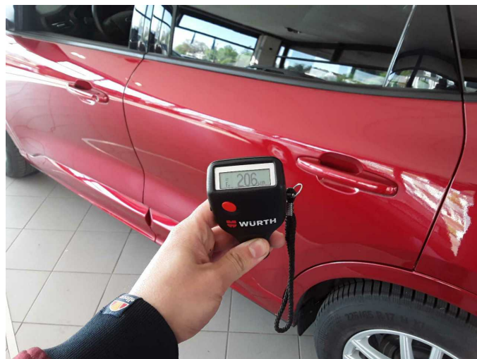
Door - rear left side: 199 µm
