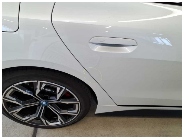
Beschädigung #2: Seitenwand rechts: Seitenwand - Delle(n) - sanft instandsetzen
