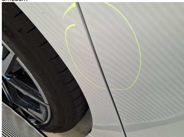
Beschädigung #2: Seitenwand rechts: Seitenwand - Delle(n) - sanft instandsetzen
