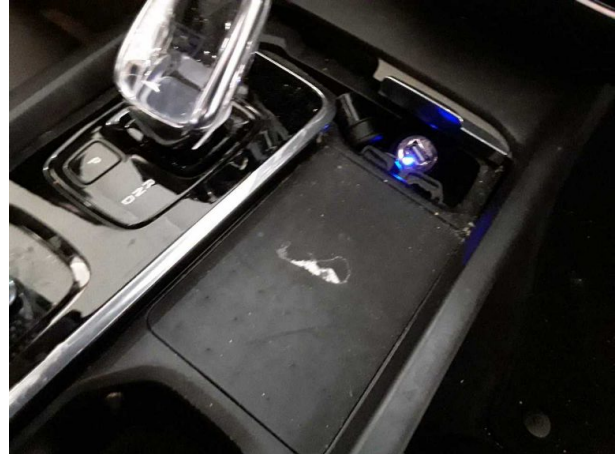
Beschädigung #3: Interieur: Innenraum (stark) - verschmutzt - reinigen
