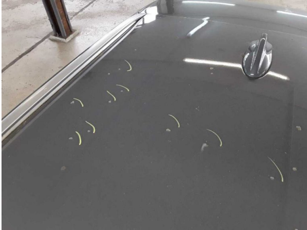
Beschädigung #4: Karosserie: Karosserie (Harz) - Lackmangel - auslegen / polieren
