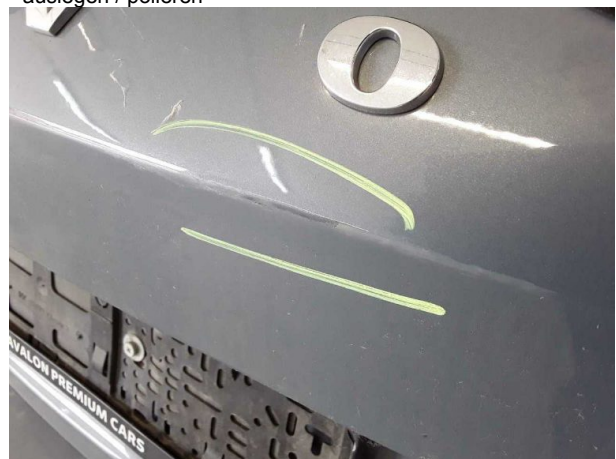
Beschädigung #5: Heckklappe/-tür: Heckklappe - verkratzt / verschürft - Smart Repair
