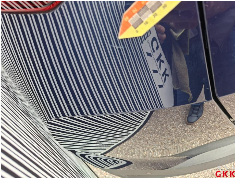
Bild 21. Stoßfänger hinten, Verkleidung -lackiert-, verkratzt, lackieren
