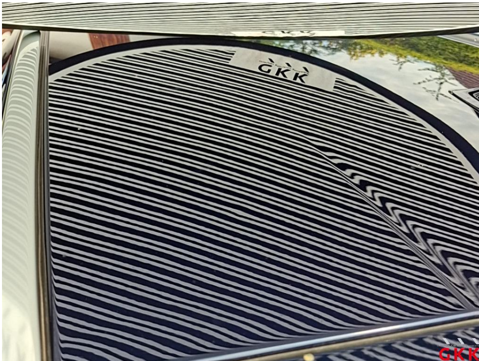
Bild 34. Fahrzeug, Hagelschaden, kalt drücken
