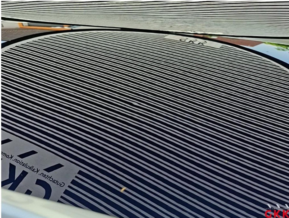
Bild 35. Fahrzeug, Hagelschaden, kalt drücken
