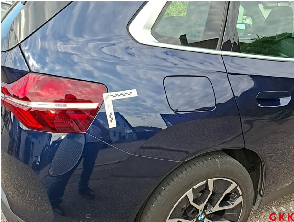
Bild 25. Seitenwand rechts, beschädigt, instand setzen - lackieren
