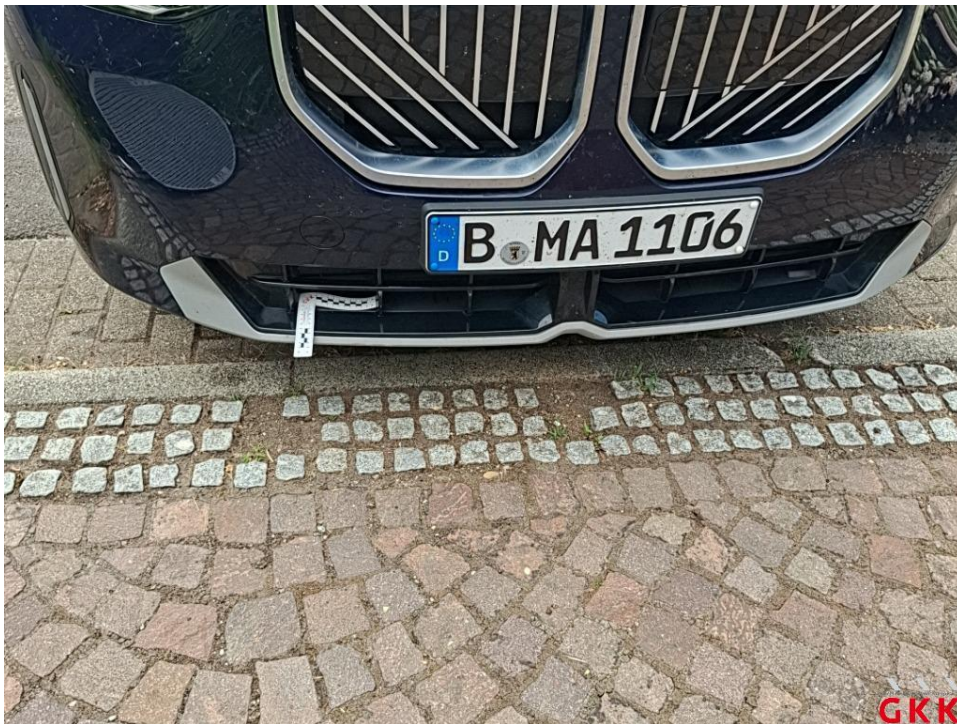
Bild 16. Stoßfänger vorne, Spoiler -lackiert-, beschädigt, ersetzen
