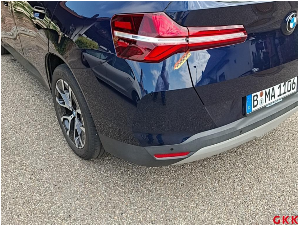
Bild 19. Stoßfänger hinten, Verkleidung -lackiert-, verkratzt, lackieren
