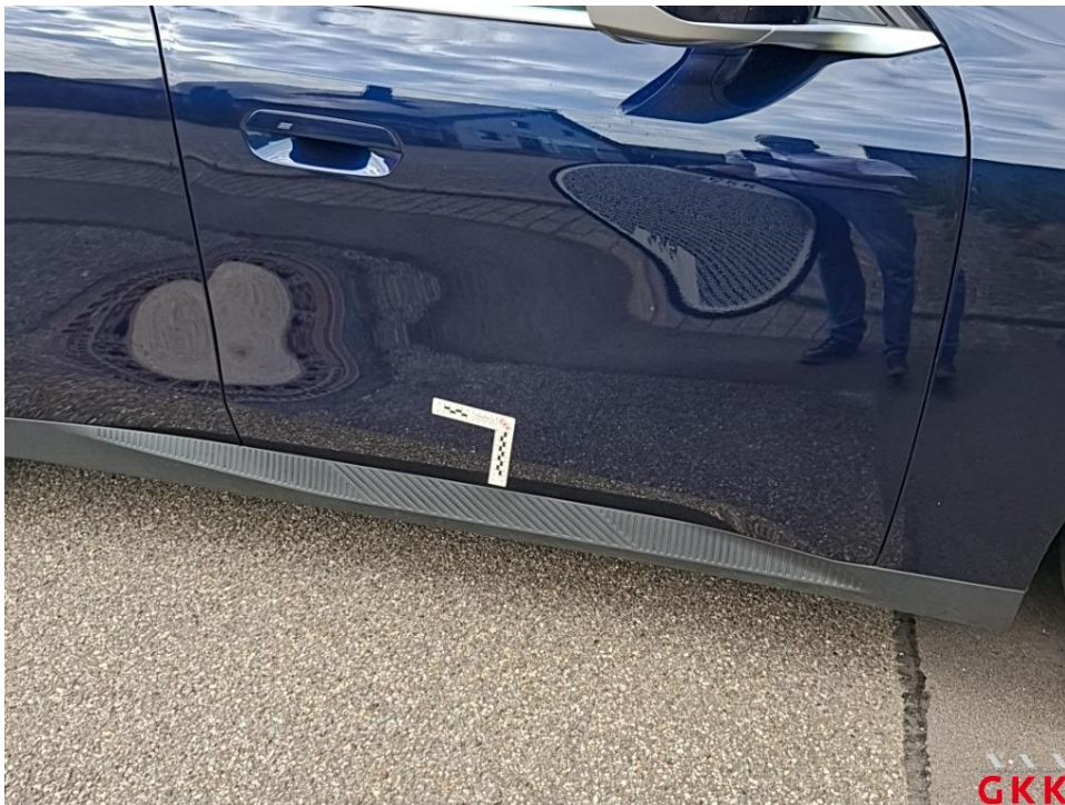
Bild 28. Tür vorne rechts, verkratzt, lackieren
