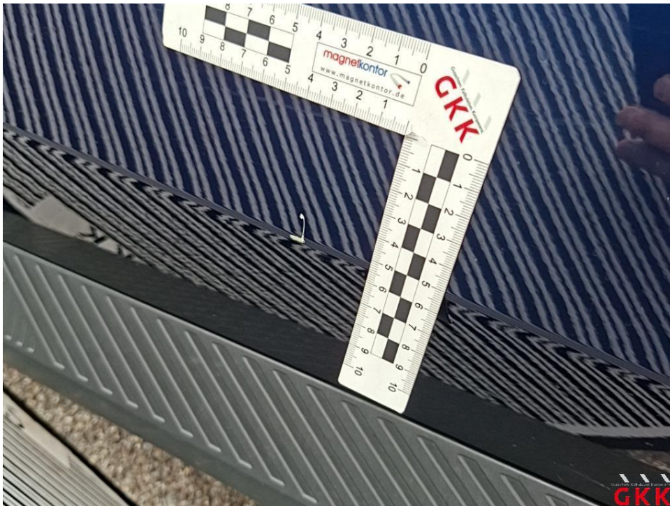
Bild 30. Tür vorne rechts, verkratzt, lackieren
