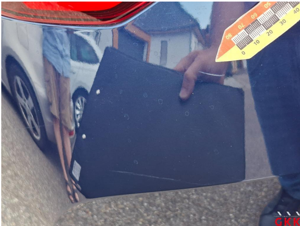
Bild 20. Stoßfänger hinten, Verkleidung -lackiert-, verkratzt, lackieren
