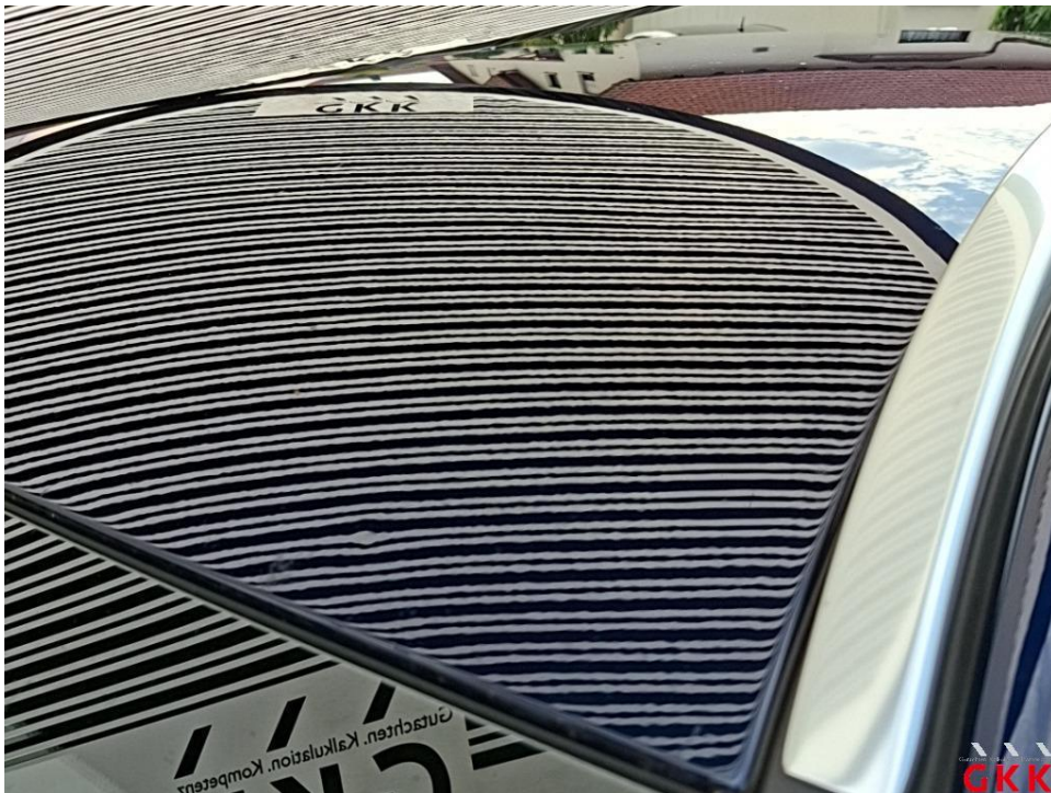
Bild 32. Fahrzeug, Hagelschaden, kalt drücken
