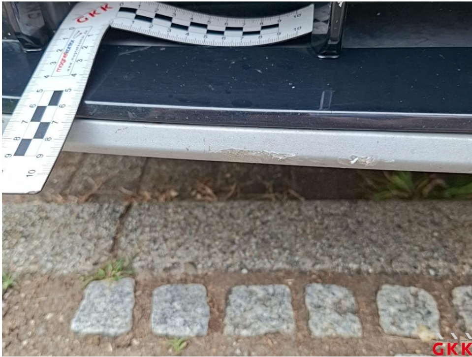
Bild 17. Stoßfänger vorne, Spoiler -lackiert-, beschädigt, ersetzen
