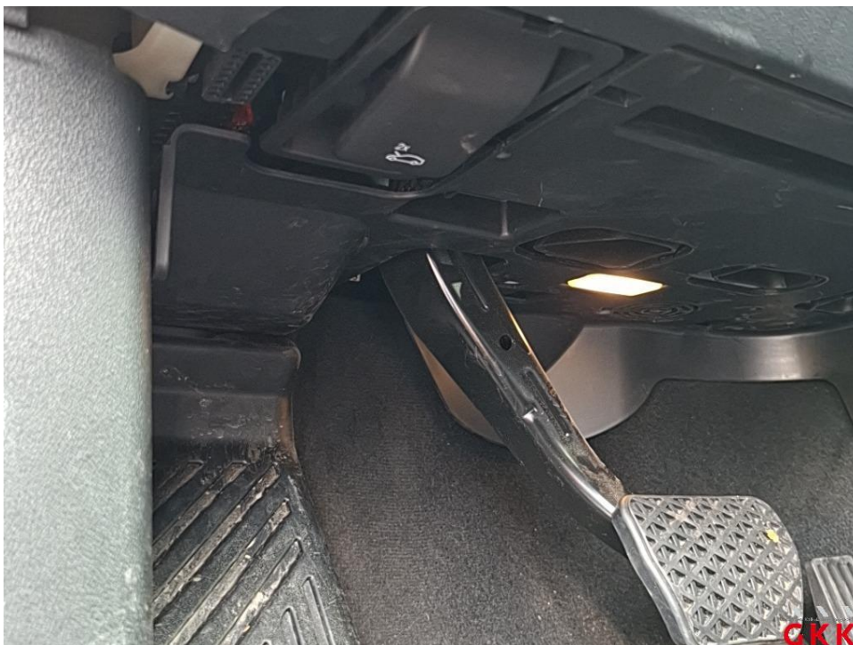
Bild 14. Motorhaube, Betätigung, defekt, prüfen
