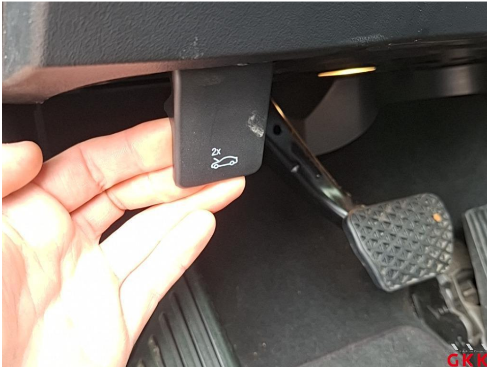
Bild 15. Motorhaube, Betätigung, defekt, prüfen
