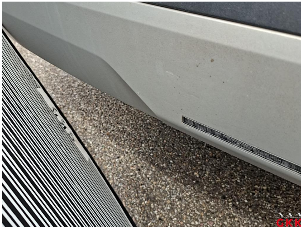
Bild 24. Stoßfänger hinten, Spoiler -lackiert-, verkratzt, lackieren
