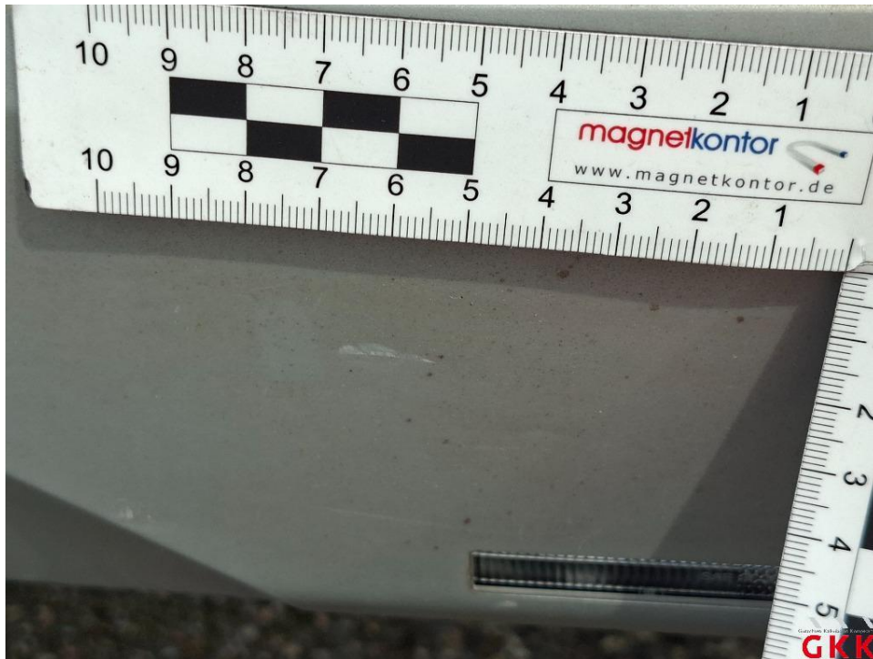
Bild 23. Stoßfänger hinten, Spoiler -lackiert-, verkratzt, lackieren
