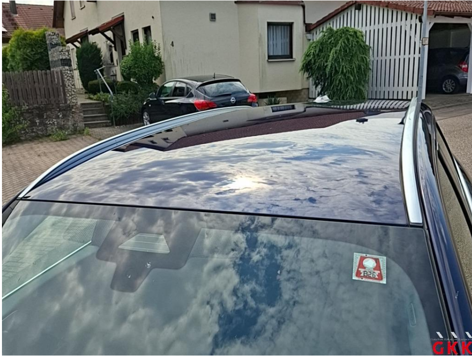
Bild 31. Fahrzeug, Hagelschaden, kalt drücken
