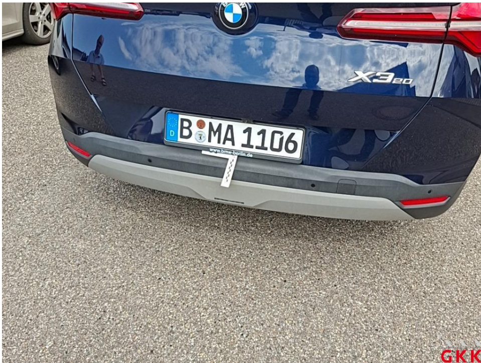
Bild 22. Stoßfänger hinten, Spoiler -lackiert-, verkratzt, lackieren
