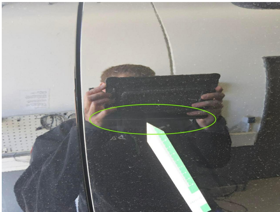
Bild 21 : Tür vorne links Lackierung, zerkratzt, Gebrauchsspur
