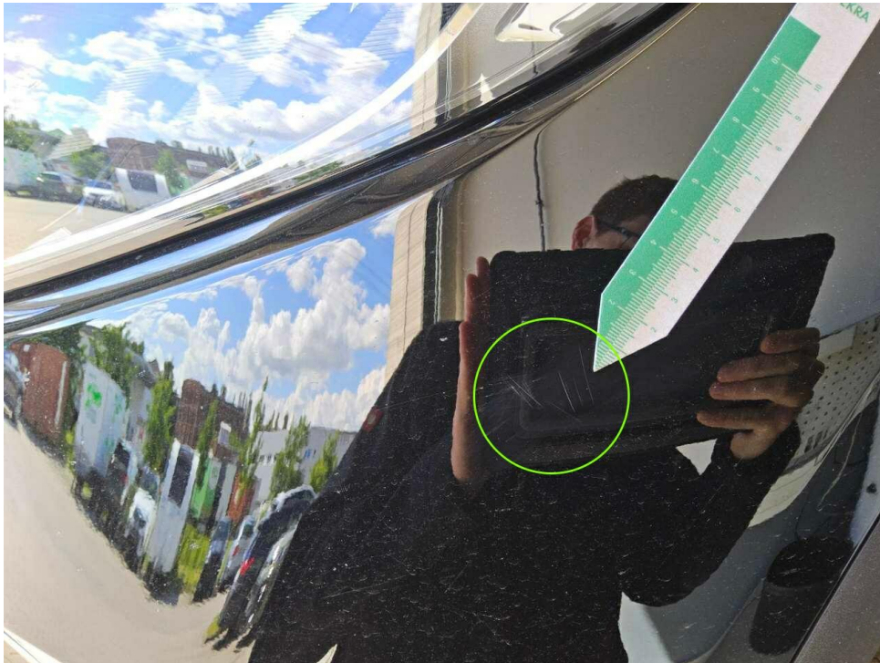
Bild 13 : Stoßfänger vorne Lackierung, zerkratzt, Gebrauchsspur
