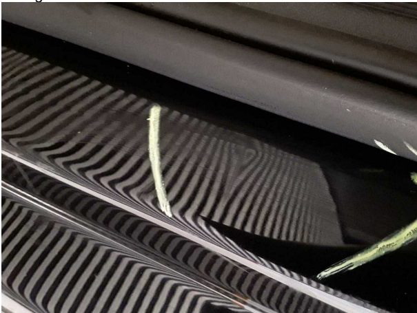
Beschädigung #3: Schweller links: Einstieg - Delle(n) - sanft instandsetzen
