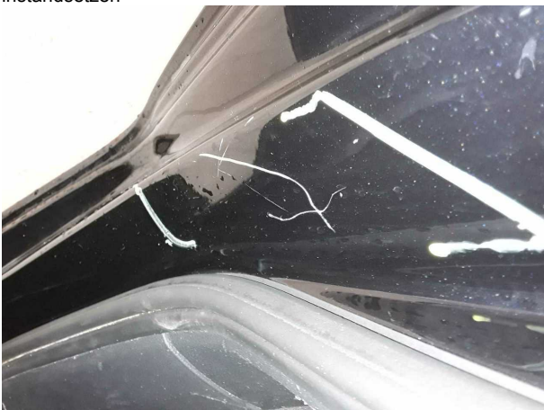
Beschädigung #4: Seitenwand rechts: Einstieg - verkratzt / verschürft - instandsetzen und lackieren
