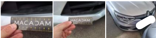
Aile AVD, Bosse(s) et griffe(s), Le - Remplacer et peindre
