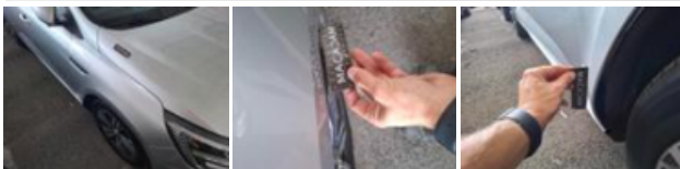
Aile AVD, Bosse(s) et griffe(s), Le - Remplacer et peindre
