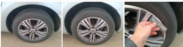
Jante alum. ARD bi-ton/polychrome, Griffes(s), Réparer/rempl. (montant forfaitaire)
